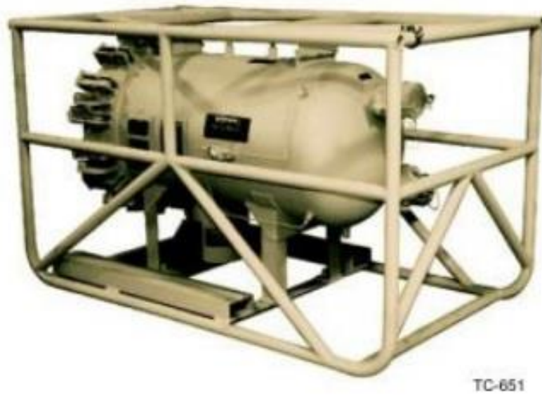
Fig. 5 Filtro separador/filtro para diésel
