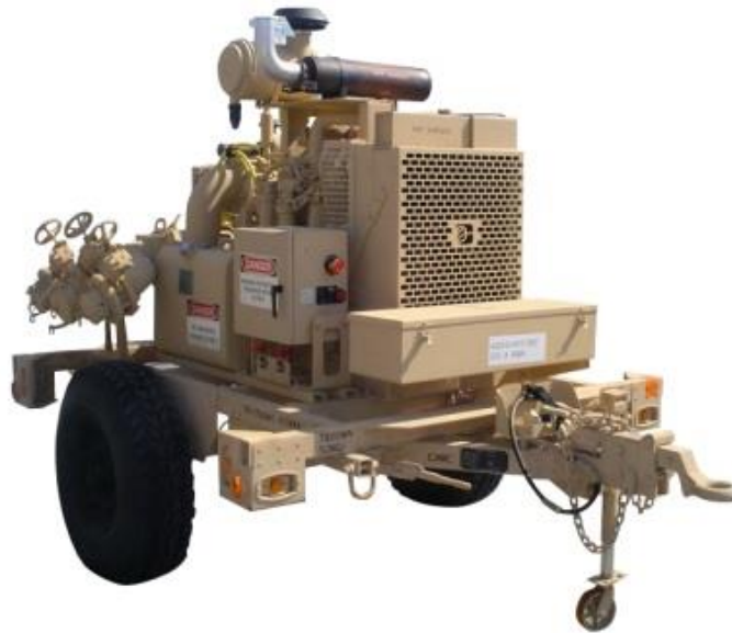
Fig. 4 Motobomba de combustible accionada por motor diésel
