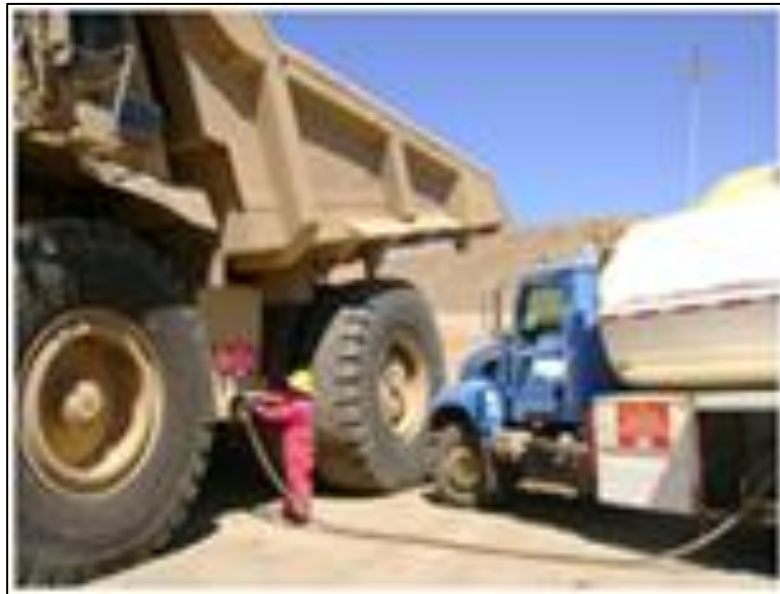
Fig. 20 Camión Aljibe en mina de rajo
