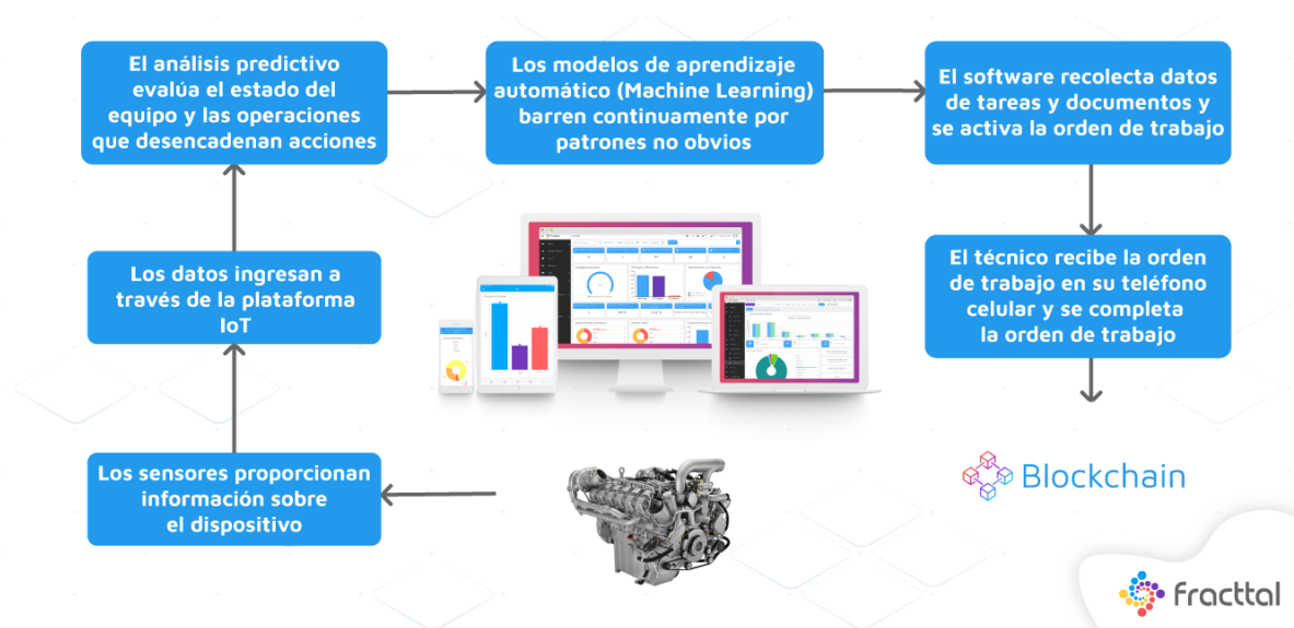
Diagrama 3-4 " Flujo de trabajo mantenimiento predictivo "
