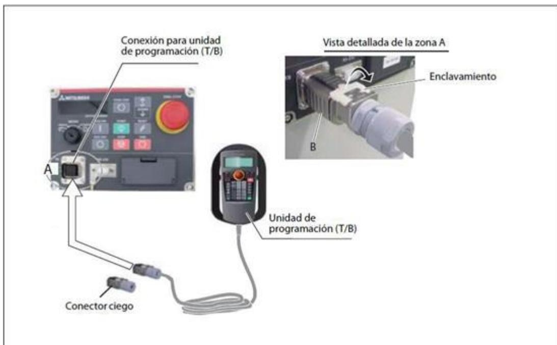
Figura 2-42: Encendido de la unidad de programación manual.
