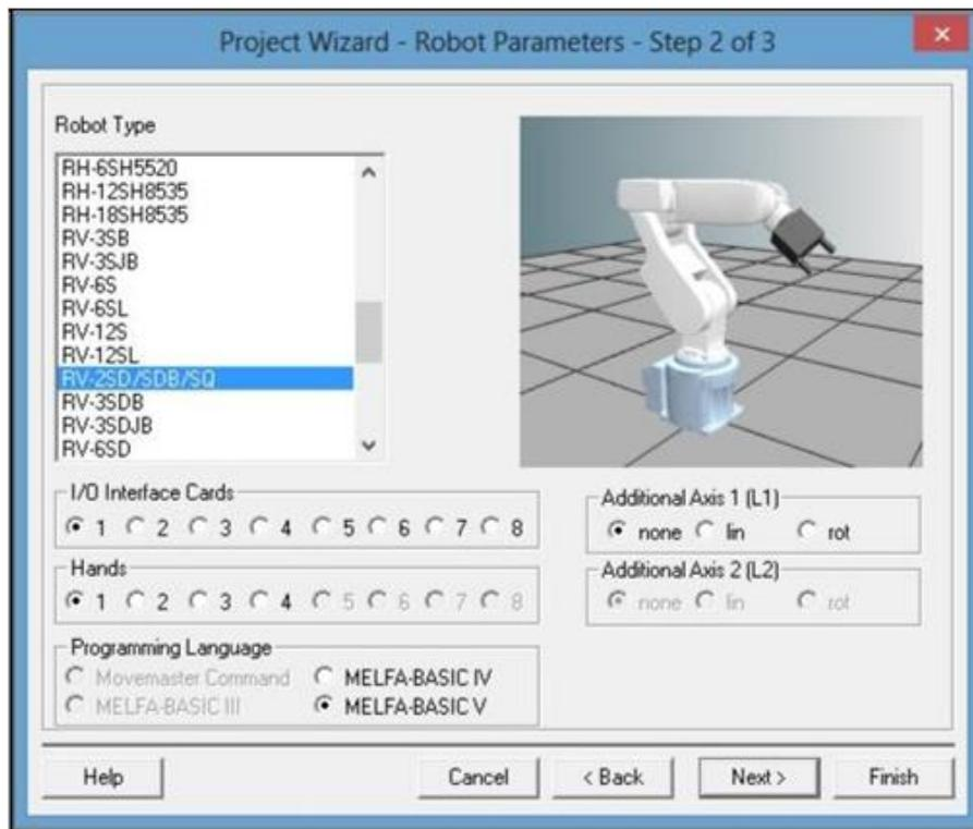
Figura 2-33: Selección del tipo de robot y lenguaje de programación.
