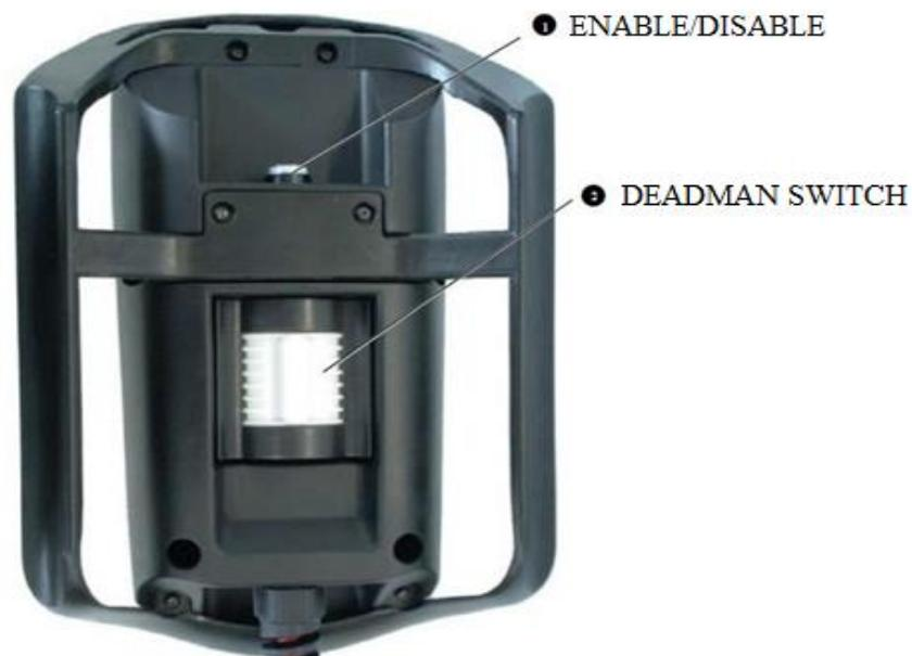
Figura 2-44: Enclavamiento de control para encendido de servos.
