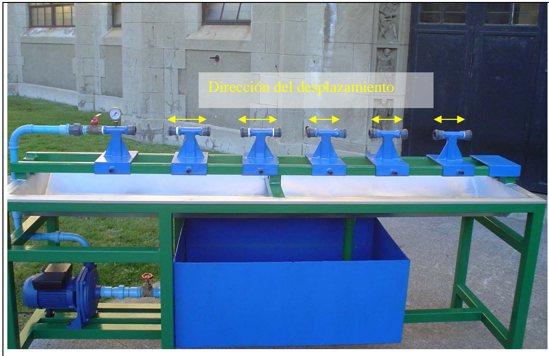
Figura 24. Soportes de los medidores, montados en la estructura (flecha indica el movimiento)
