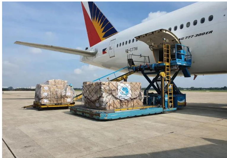
Figura 2-9: Procedimiento de carga de ULD a la bodega delantera con un cargolader. (Joloda. (s.f.). Almacenamiento de ULD. Sitio web de Joloda. Recuperado de https://www.joloda.com/es/equipos-de-carga-aerea/soluciones/almacenamiento-de-uld/ ).
