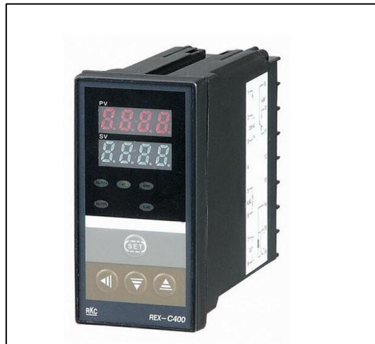
Figura 4.7. Regulador de temperatura marca RKC modelo Rex-C400 conectado al equipo.
