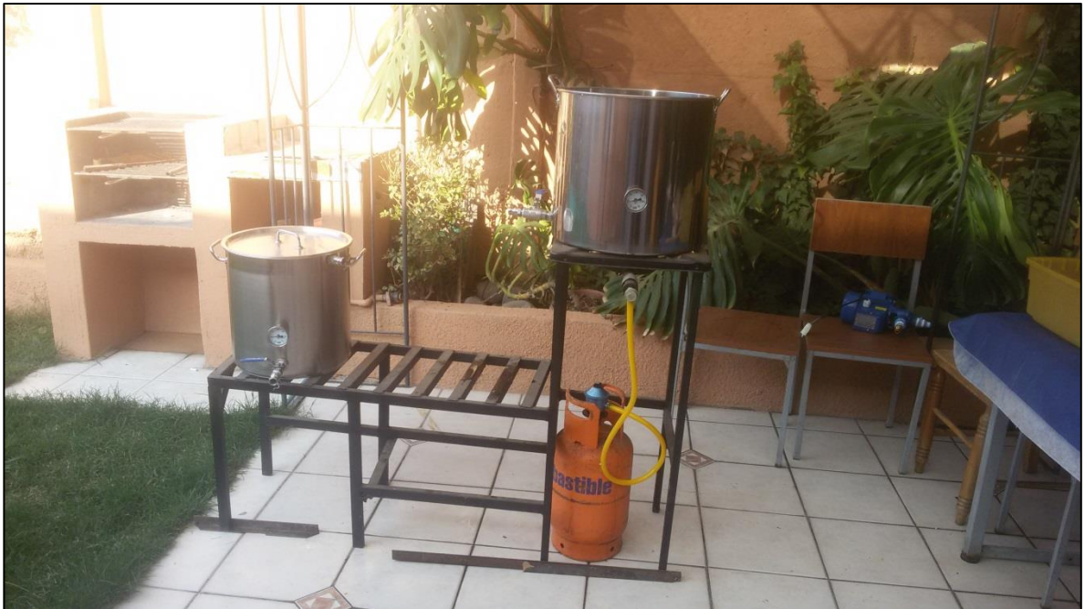
Figura 3.1. Disposición tradicional de elaboración de cerveza artesanal. Maceración.
