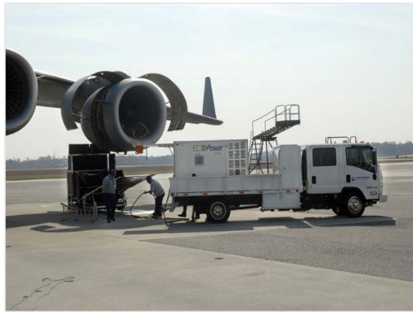
Figura 3.36 Representación de uso sistema EcoPower (U.S Air Force, 2010).
