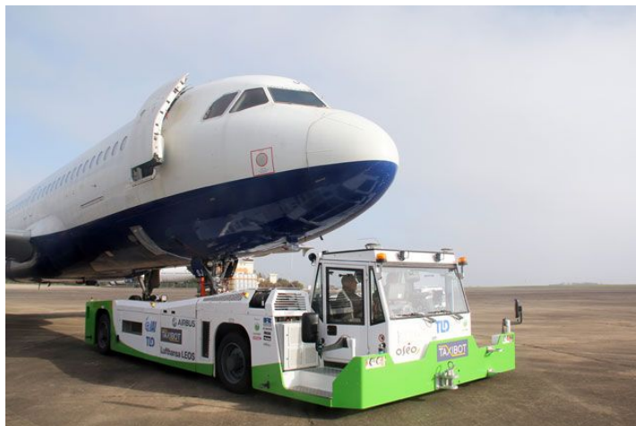
Figura 3.20 Muestra el funcionamiento del TaxiBot con la aeronave conectada (Tree Hugger, 2013).
