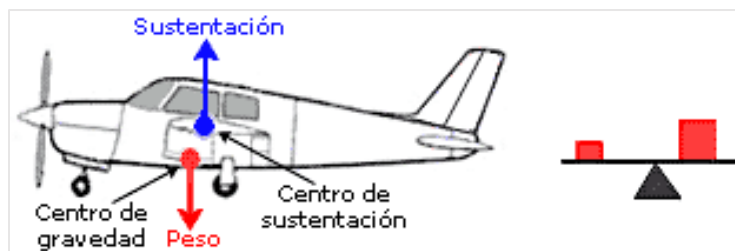
Figura 3.37 Fuerzas que interactúan con el centro de gravedad de la aeronave (Manual Vuelo, 2014).
