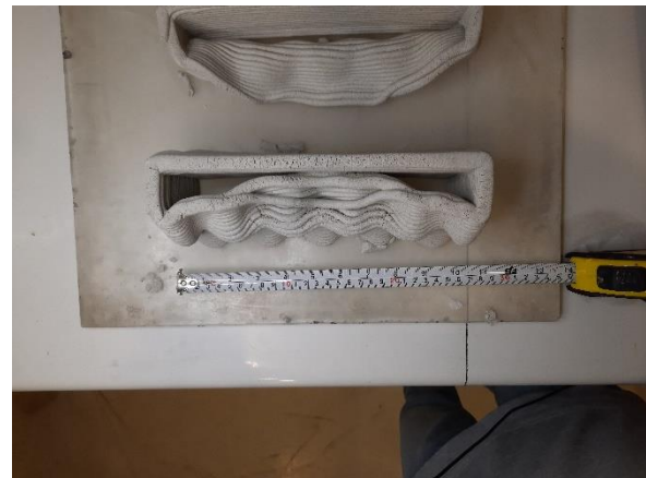
Figura 10. Fotografías modelos impresos resultantes día 7, medición de largo y alto modelo C.
