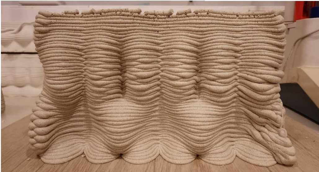
Figura 23. Fotografía resultado impresión modelo B día 12, detalle en uso de fibras zona inferior derecha.
