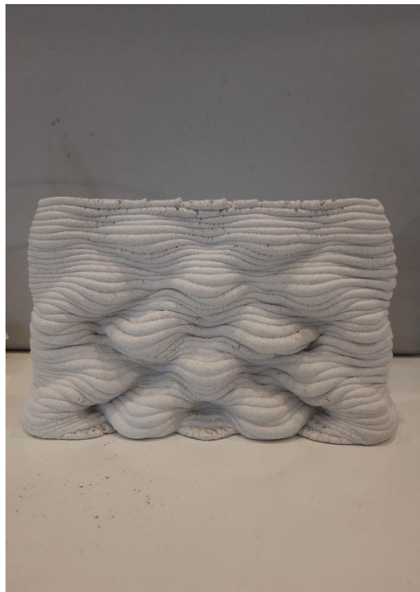
Figura 29. Fotografía resultado impresión modelo B día 13.
