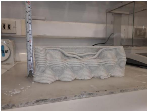
Figura 10. Fotografías modelos impresos resultantes día 7, medición de largo y alto modelo C.
