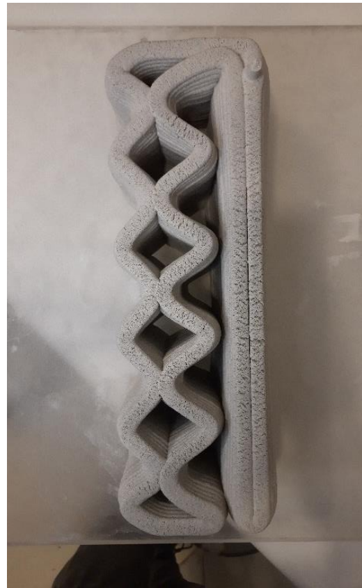
Figura 11. Fotografía cenital modelo impreso día 8, muestra del grosor cordón de impresión y cavidades del muro.
