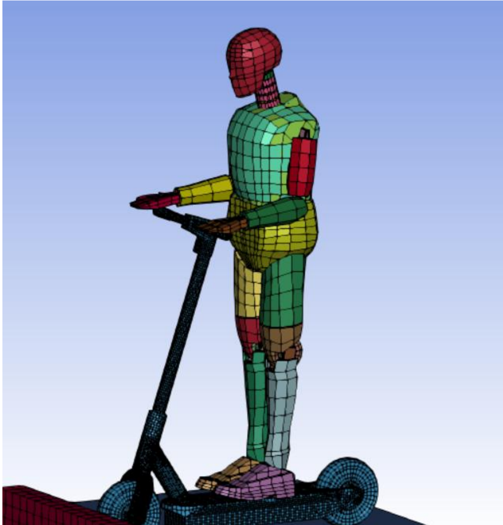
Figura 8 Modelo de Elementos Finitos LSTC Hybrid III 50th Percentile Male Standing Dummy configurado sobre el scooter eléctrico
