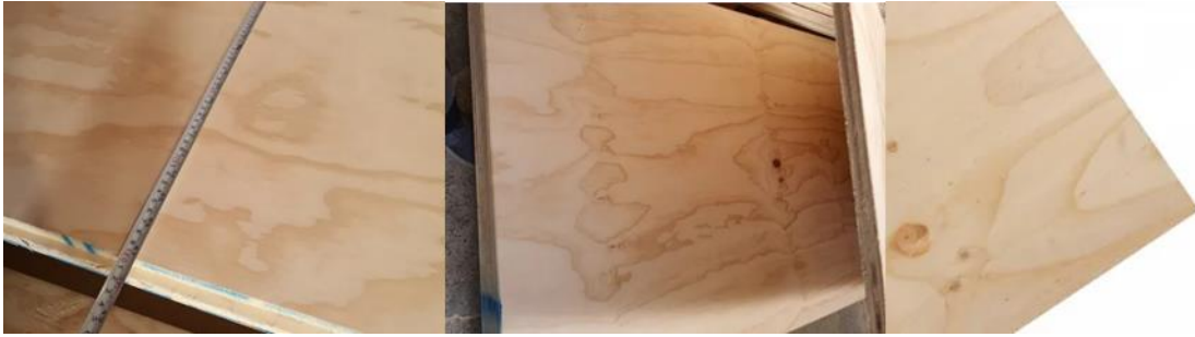
Imagen 1-3: Terciado Estructural 9mm para bases y niveles.
