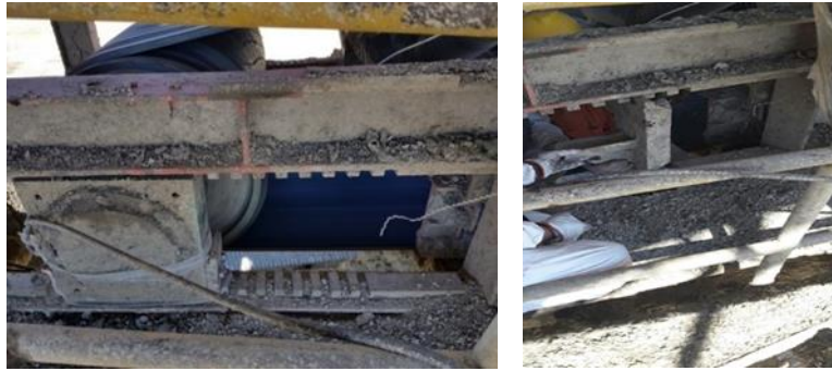
Figura 2-6. Cremallera de fijación; izq. Cremallera - der. soportes estructurales.
