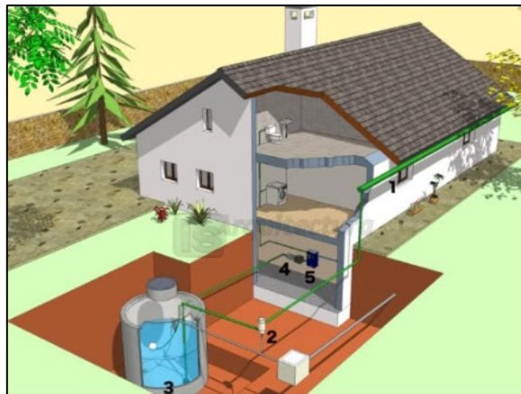
FIGURA 1 - Captación, 2.- Filtro, 3.- Depósito, 4.- Bomba, 5.- Conmutado y/o control
