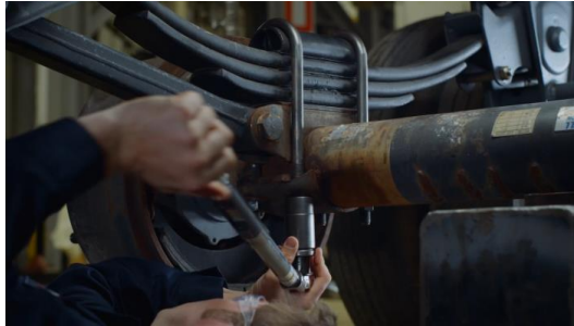
Figura 42, reapriete pernos tipo U. Fuente: hutchensindustries.com.
