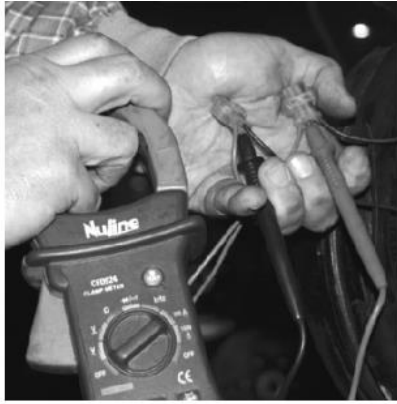
Figura 13 correcta medición de amperaje
