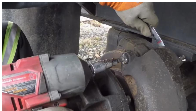
Figura 18, extracción de pasadores de las pinzas. Fuente: YouTube/K30krazy channel
