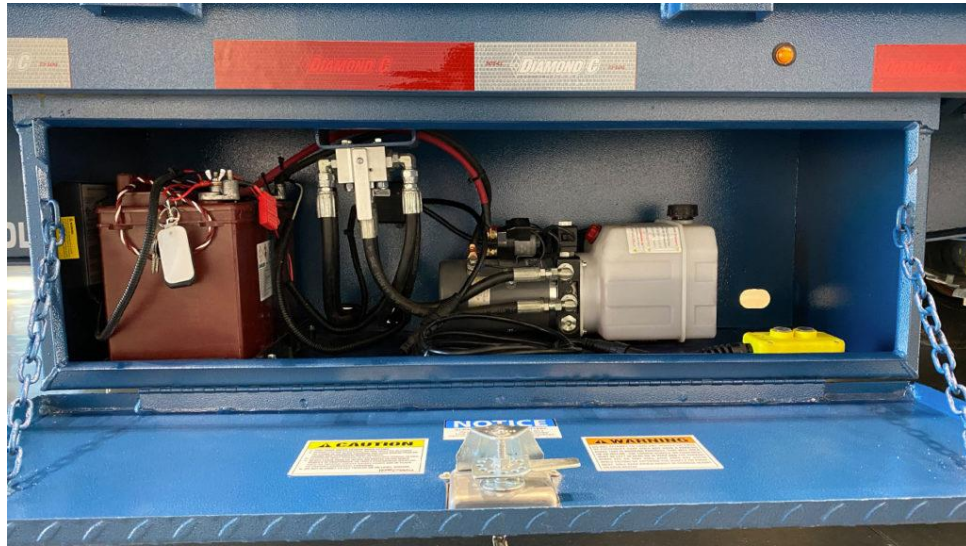
Figura 3 Fuente de poder hidráulica en gaveta lateral Fuente: diamondc.com
