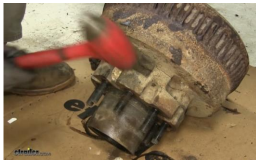
Figura 10, desacople con martillo. Fuente: etrailer.com
