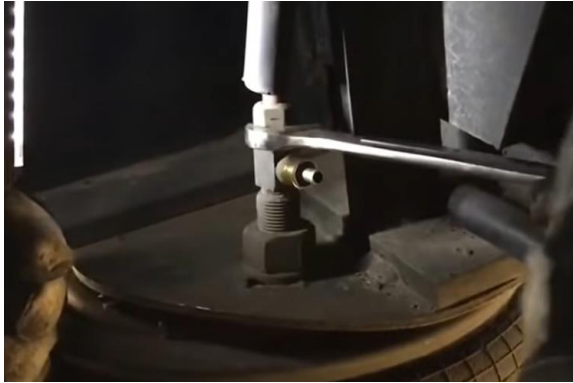
Figura 36, Desmontaje de niples de alimentación de aire.
