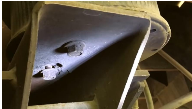
Figura 37, Pernos inferiores del resorte de aire.
