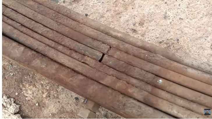
Figura 40, Hojas de ballesta rotas. Fuente: YouTube/CarlosMOLTIRchannel.
