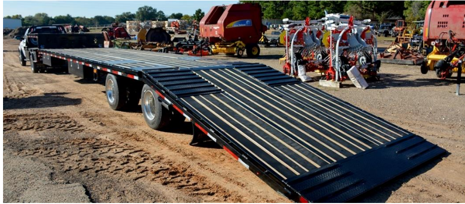
Figura 18 Cola de milano hidráulica Fuente: diamondc.com
