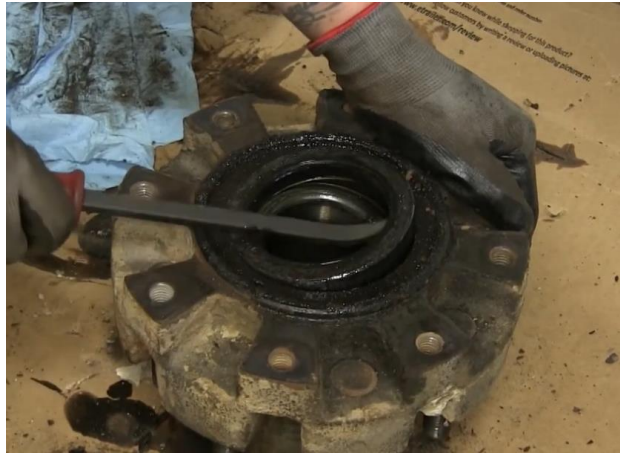
Figura 2, Remoción de un retén. Fuente: YouTube/revHD channel
