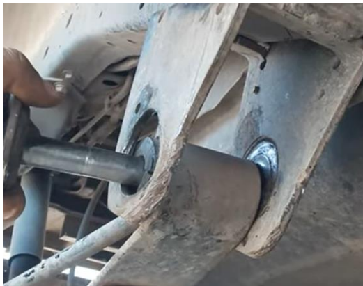
Figura 45, pasador del casquillo. Fuente: youtube/d21pickup channel.
