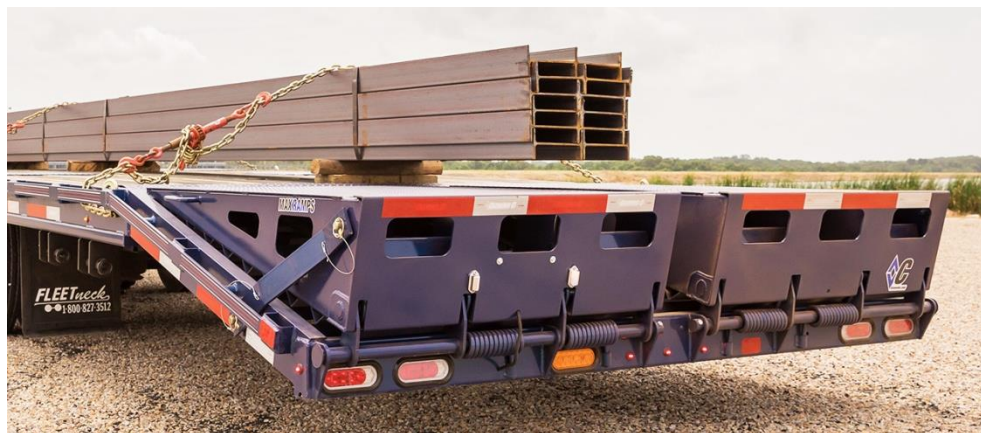
Figura 15 Cola de un remolque cuello de cisne Fuente: diamondc.com
