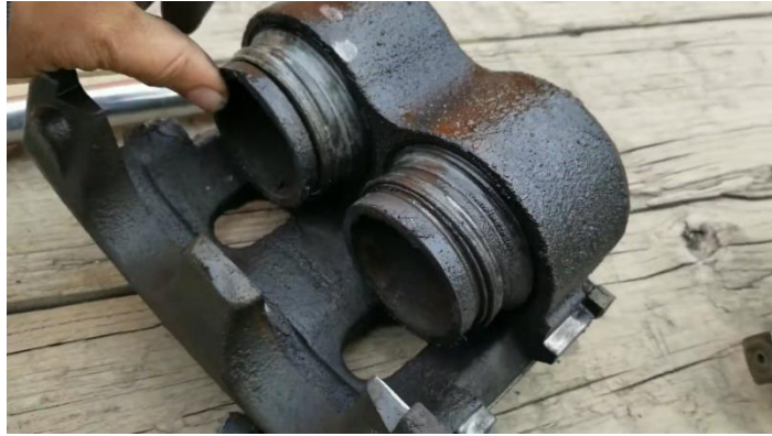
Figura 26, pinza en mal estado por calentamiento. Fuente: YouTube/Ak road service channel
