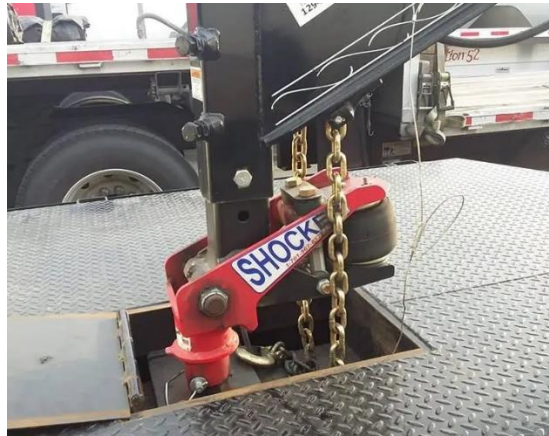
Figura 14 Amortiguador neumático del acople de bola Fuente: shockerhitch.com
