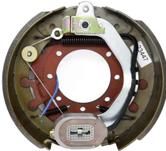
Figura 11, conjunto de balatas de freno. Amazon.com
