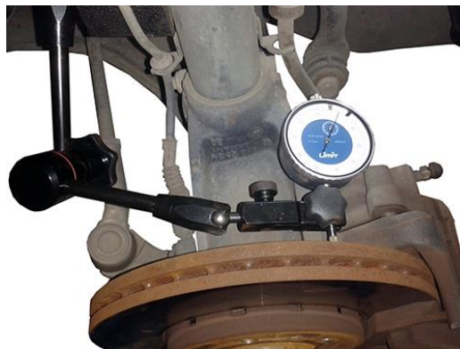
Figura 20, medición de alaveo del disco. Fuente blogmecanicos.com
