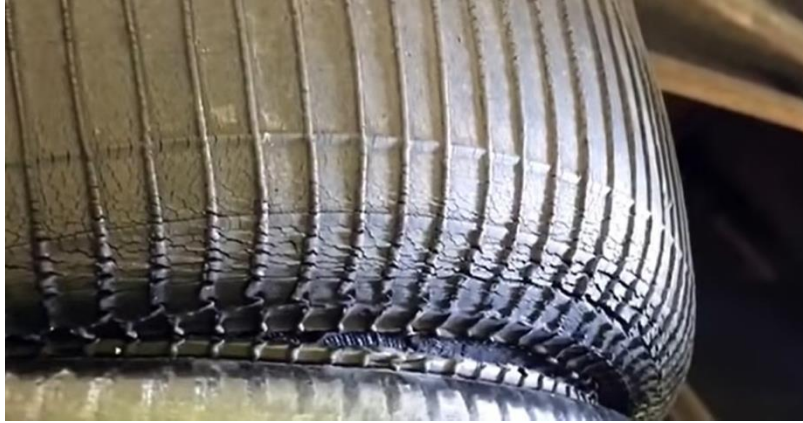
Figura 35, resorte en mal estado.
