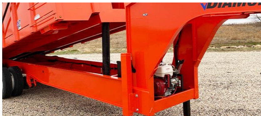
Figura 23 Remolque de volquete con motor a bencina Fuente: diamondc.com
