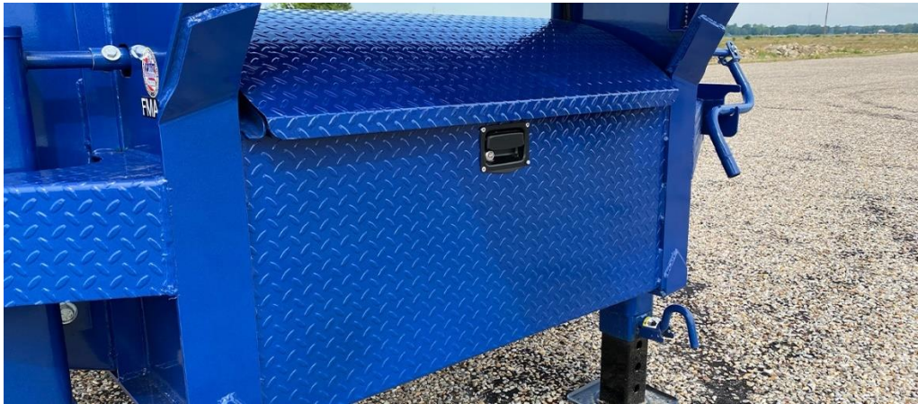
Figura 24 Gaveta de almacenaje en un modelo FMAX 212 Fuente diamondc.com
