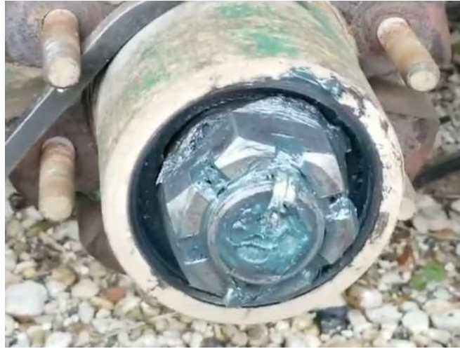
Figura 1, Tuerca almadrada con chaveta. Fuente: YouTube/Ak road service Channel
