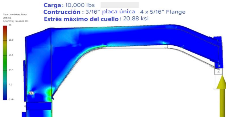
Figura 7 Prueba de estrés (vigas de ingeniería) Fuente: diamondc.com
