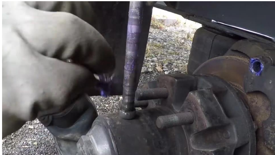
Figura 28, lubricación del pasador de la pinza para su instalación. Fuente: YouTube/K30krazy channel.
