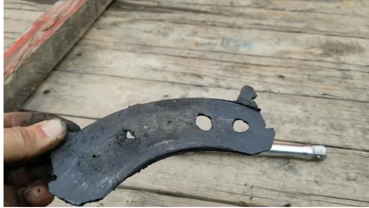
Figura 25, desgaste extremo de pasilla de freno. Fuente: YouTube/Ak road service channel.
