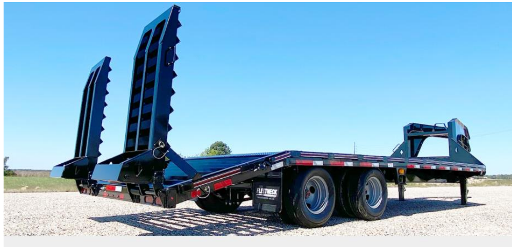
Figura 17 Remolque con rampas de rodilla para servicio pesado Fuente: Diamondc.com
