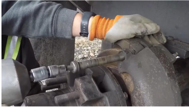
Figura 19, extracción de pasadores de las pinzas. Fuente: YouTube/K30krazy channel
