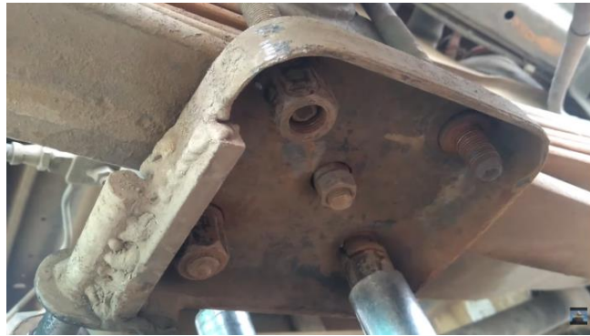
Figura 46, Extracción de pernos U. Fuente: YouTube/CarlosMOLTIRchannel.
