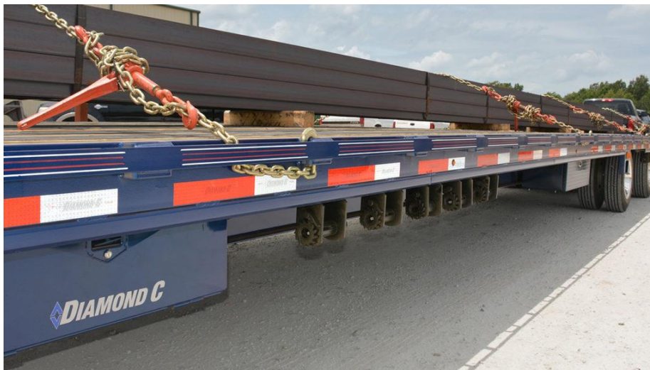
Figura 4 Trinquetes deslizantes Fuente: diamondc.com
