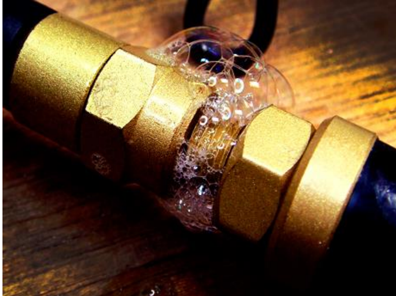
Figura 34, Fuga en un acople. Fuente: colflex.com
