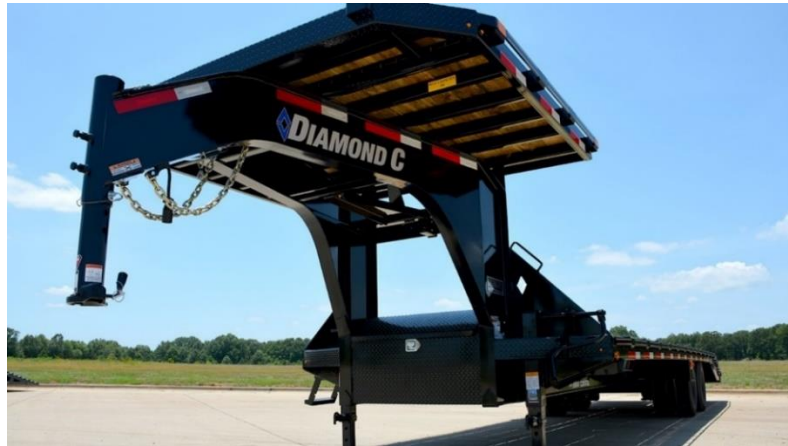
Figura 22 Remolque con plataforma sobre el cuello de cisne Fuente: diamondc.com
