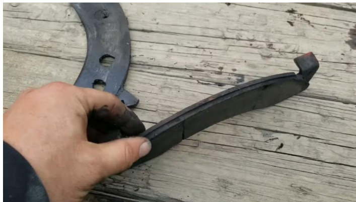
Figura 24, desgaste de pastillas de freno. Fuente: YouTube/Ak road service channel.
