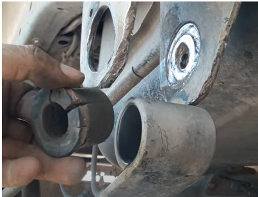
Figura 44, casquillo en mal estado. Fuente: YouTube/d21pickupchannel
