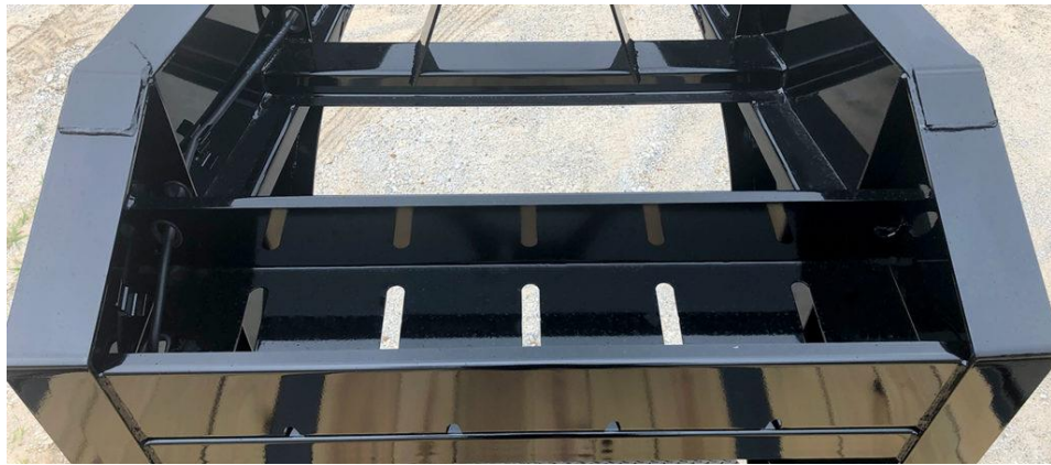
Figura 21 Bandeja porta cadenas Fuente: diamondc.com
