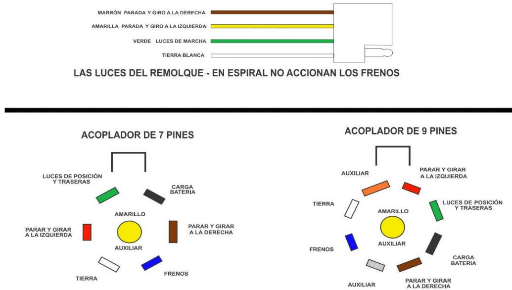
Figura 16, coloración el cableado en el enchufe del remolque. Fuente: diamondc.com
