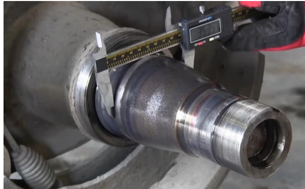
Figura 3, medición diámetro espiga 3-9. Fuente: YouTube/revHD channel
