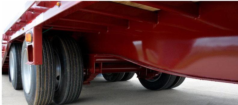
Figura 2 Remolque con tecnología de vigas de ingeniería Fuente: diamondc.com
