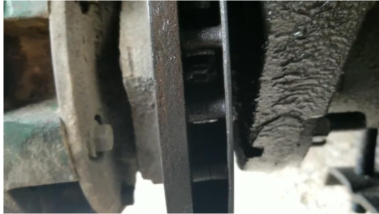
Figura 23, desgaste irregular del disco de frenos. Fuente: YouTube/Ak road service channel
