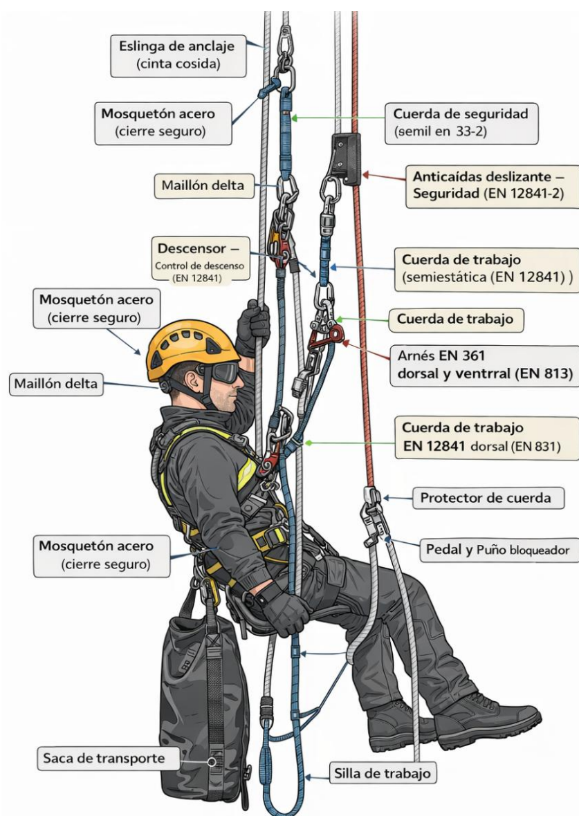
Figura 3-3: Sistema personal de acceso por cuerdas
