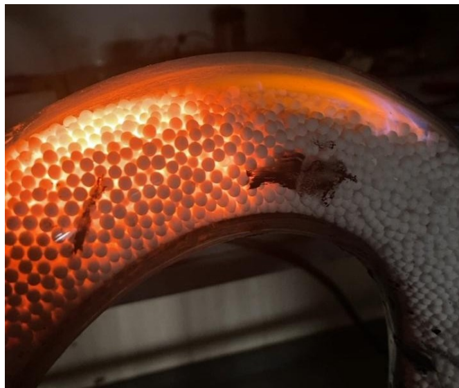
Figura 7.16: Frente de combustión viajando por el medio poroso con porción sin esferas
