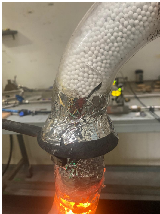
Figura 9.9: Fisura causada por la dilatación térmica del inyector
