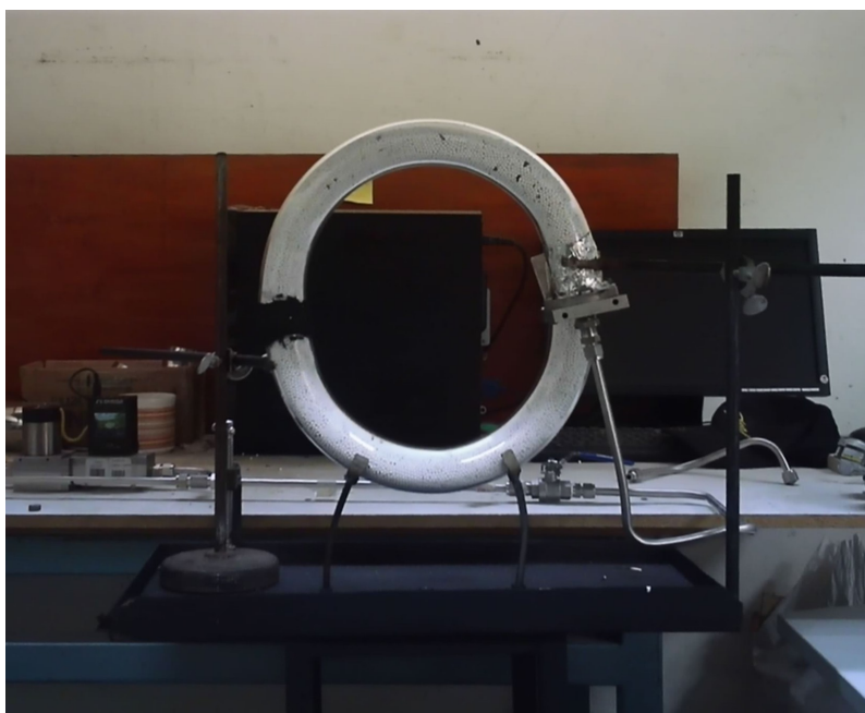
Figura 5.2: Quemador tipo O instalado
