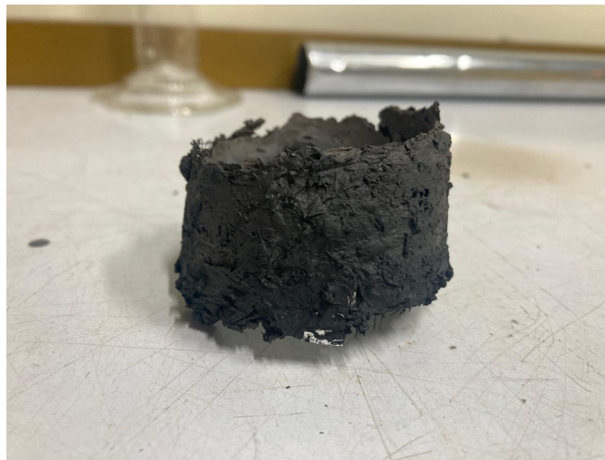
Figura 7.17: Masilla refractaria totalmente calcinada retirada posterior a los ensayos
