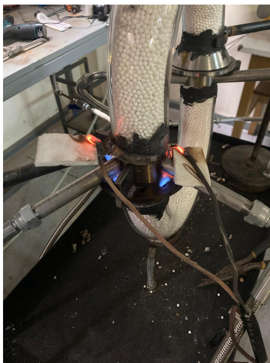
Figura 9.6: LLama libre en escapes del reactor tipo O
