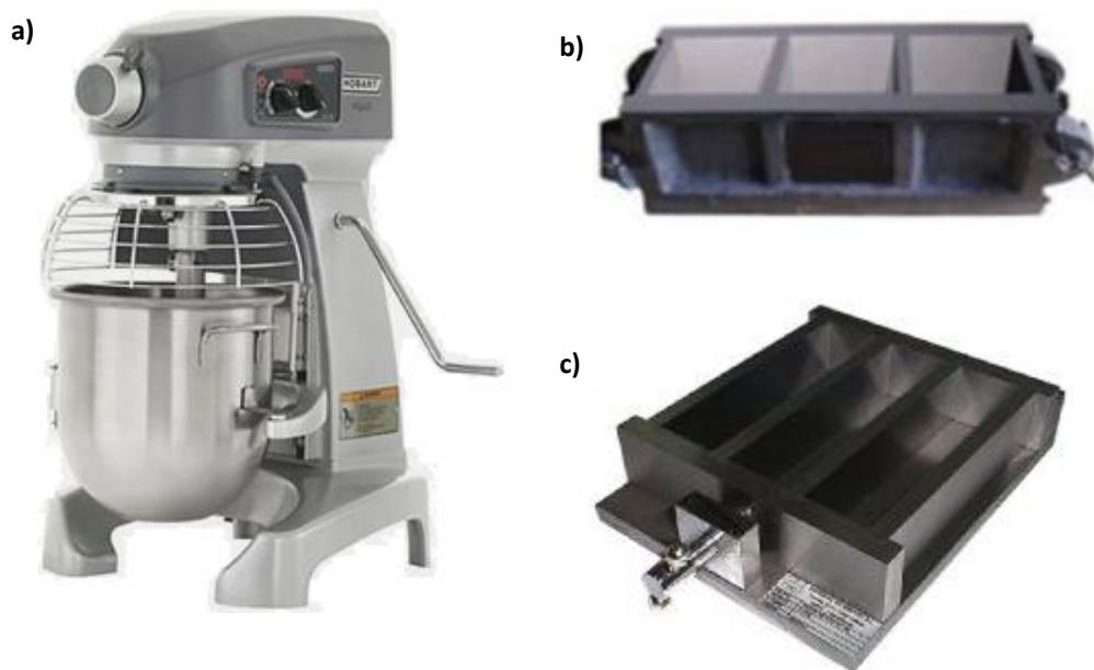
Figura 5 - 1: a) Mezcladora Hobart modelo HL120. b) Molde para probetas cúbicas 5x5x5 cm. c) Molde para probetas prismáticas 16x4x4 cm.
