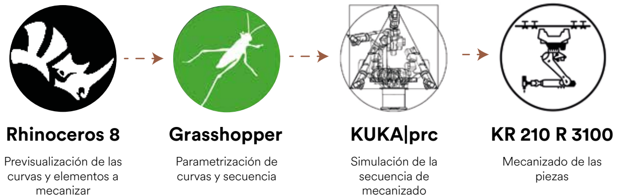
Figura 58. Flujo de trabajo para la elaboración de los mecanizados. Elaboración propia
