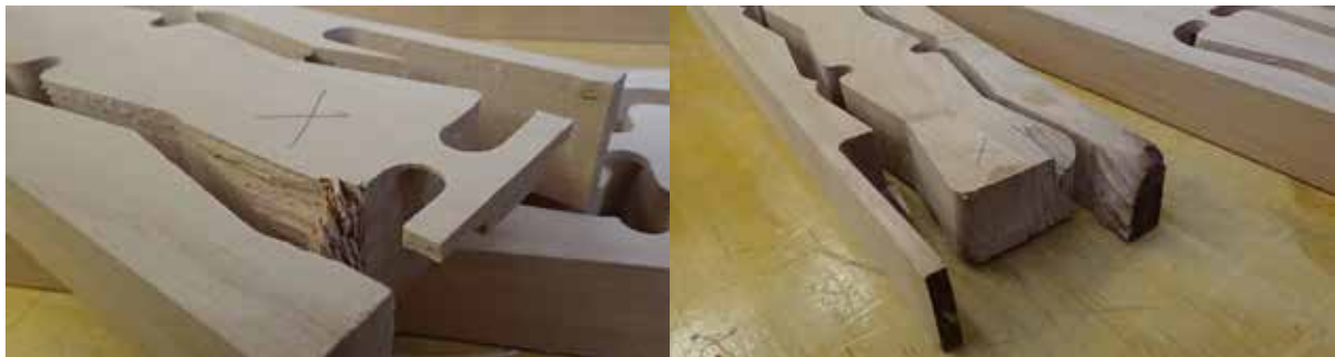
Figura 66. Fotografías de prueba N°2 fallida. Elaboración propia
