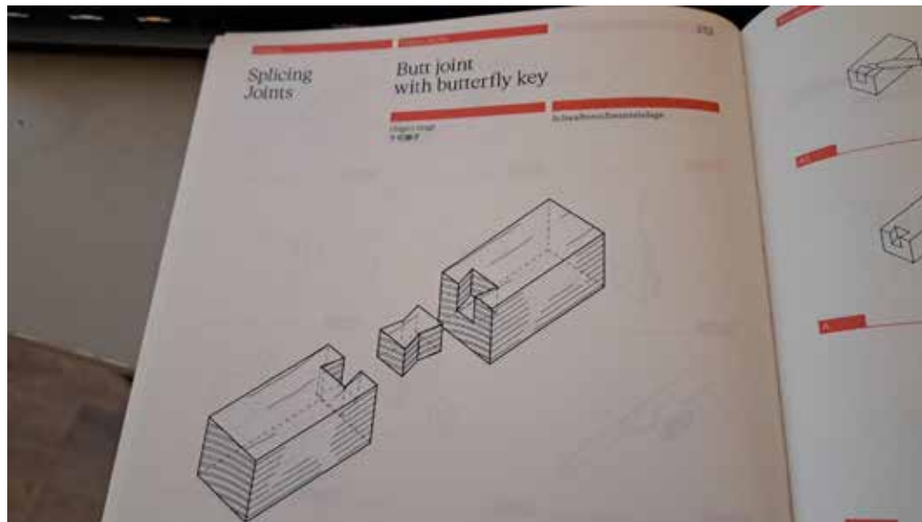
Figura 35. Demostración bibliográfica de unión tipo llave. Fuente: The Joinery Compendium. Learning from Traditional Woodworking (2024)
