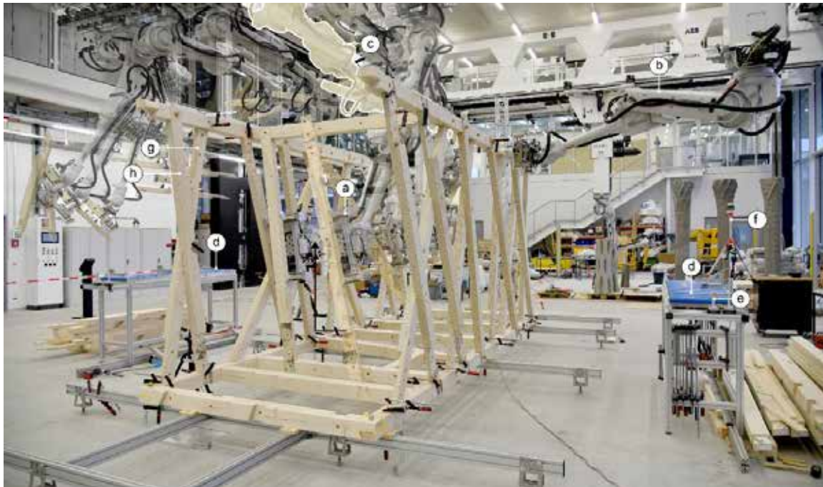
Figura 09. Flujo orientado al trabajo con brazos robóticos. Fuente: Helmreich et al. (2022)
