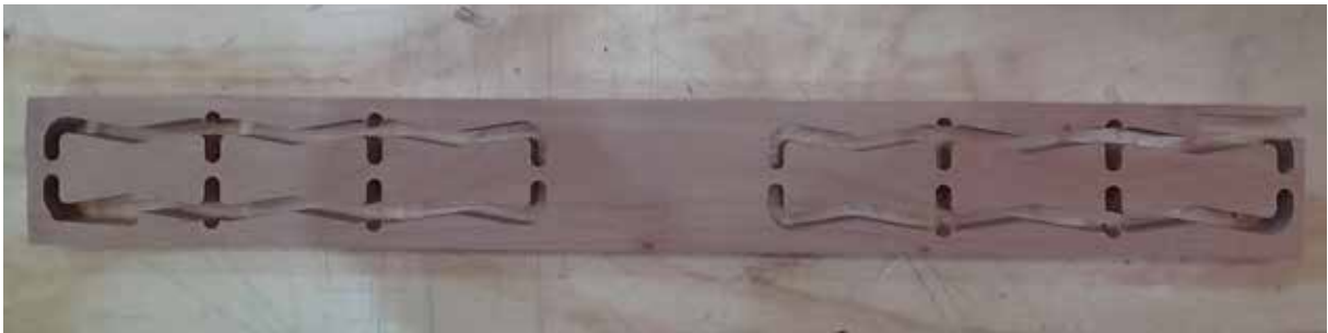
Figura 68. Fotografía de pieza completa mecanizada por ambos extremos, sin cortar con ingleteadora. Elaboración propia
