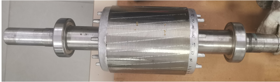
Figura 4.1: Vista del rotor en estado sano antes de la intervención.
