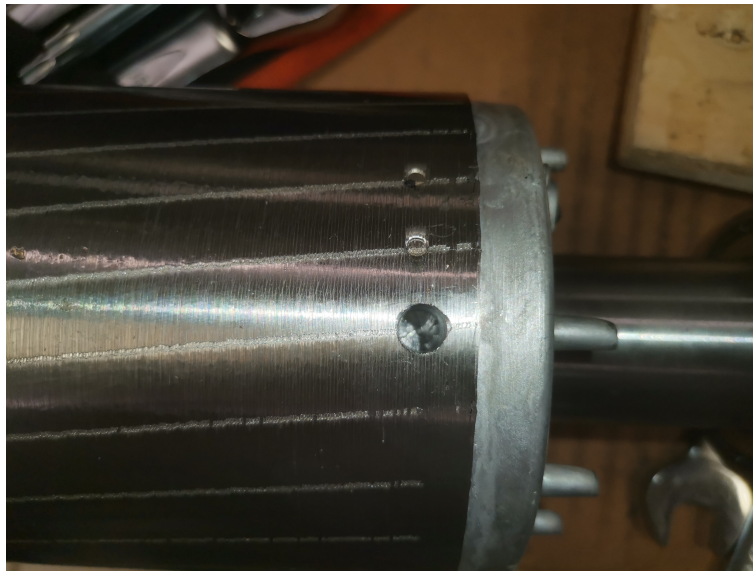
Figura 4.2: Detalle de la perforación realizada en la Máquina 220201077 para emular la ruptura de barra.
