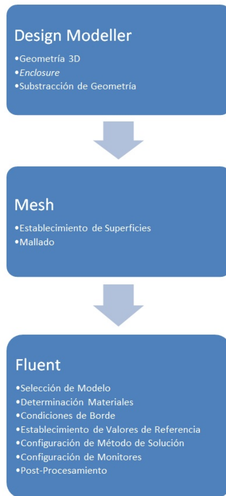
Figura 4.16: Diagrama de flujo de trabajo del modo “Fluid Flow (Fluent)”.
