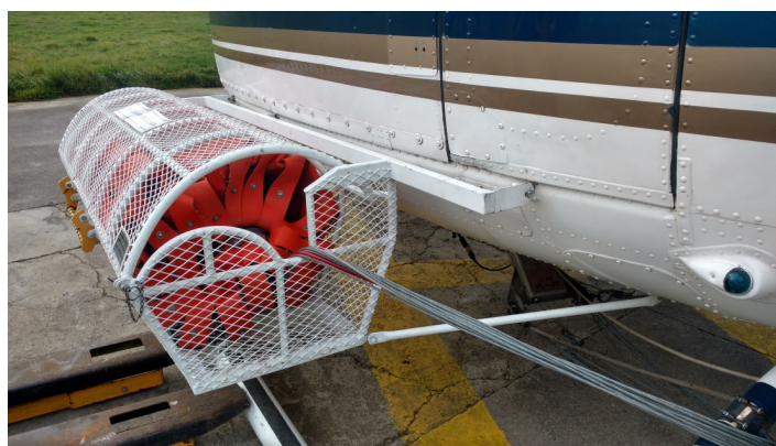
Figura 2.4: Vista en detalle Tensores Canastillo HUB1.
