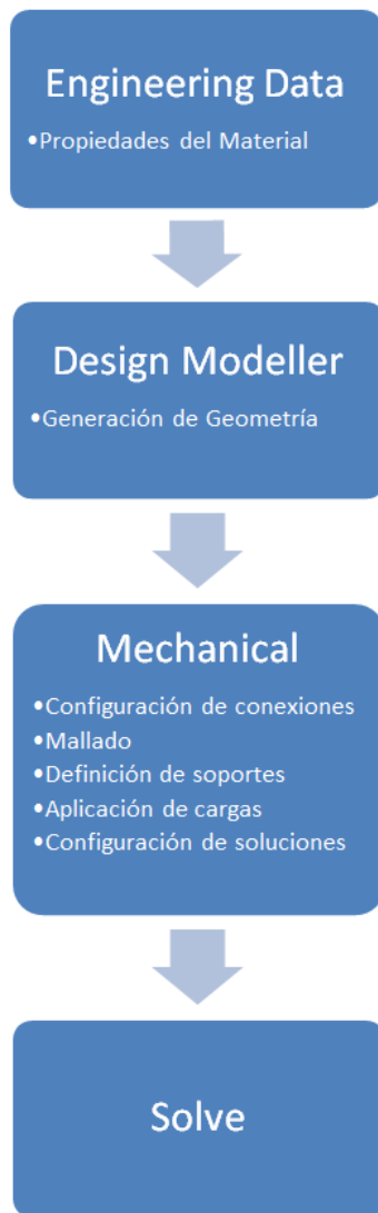
Figura 4.36: Diagrama de flujo de trabajo del modo "Statitic Structural".
