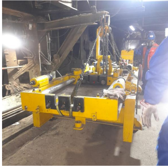
Figura 16 Retiro/instalación de máquina punzadora de CPS.
