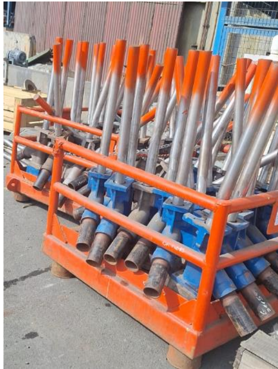
Figura 14 Conjunto de toberas reparadas desde maestranza.
