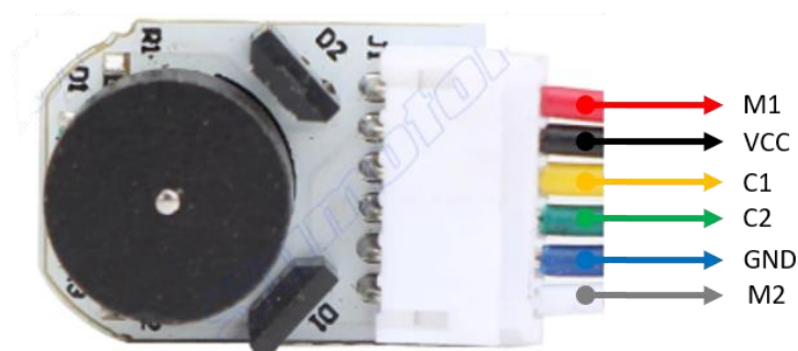
Figura 54: Conexiones del conector JST de 6 pines del motor y encoder. La salida posee un conector hembra, mientras que el conector macho está asociado a los cables de conexión que se observan a la derecha en colores.
