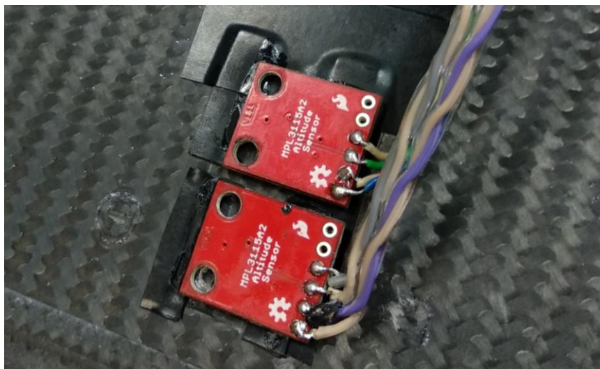
Figura 69: Vista inferior del manto. Los sensores fueron instalados usando cinta aislante como base y luego las esquinas de las placas fueron pegadas usando cianocrilato.
