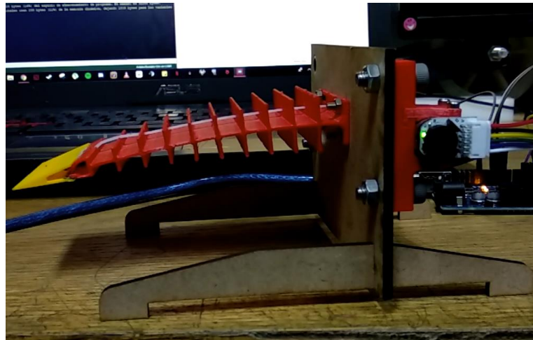
Figura 55: Primera probeta modular para pruebas del módulo actuador. Se observa la flexión del sistema provocada por la acción del motor acoplado al lado derecho.
