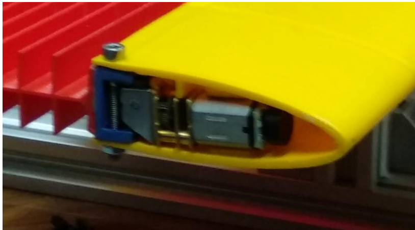
Figura 62: Motor instalado en la probeta. Se realizó un corte en diagonal en la carcasa para poder instalarlo en su posición sin modificar el tamaño del modelo impreso con anterioridad.
