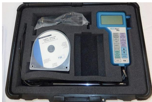
Figura 74: Anemómetro de alambre caliente marca TSI, modelo VelociCalc Plus 8386.
