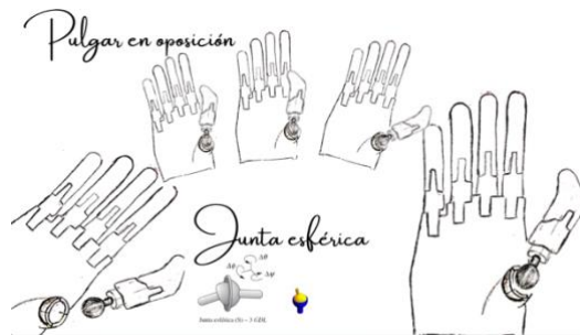
Imagen 44: Sistema junta esférica Fuente: Elaboración propia
