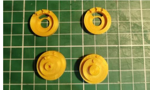
Imagen 44: Prueba de mecanismo de rotación pulgar Fuente: Elaboración propia
