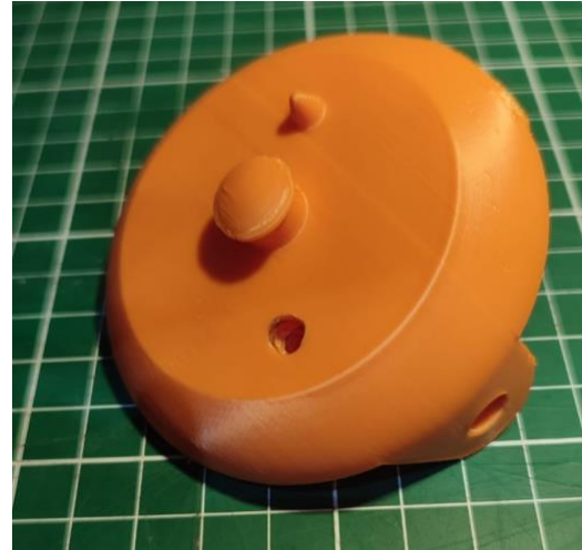
Imagen 44: Primera prueba de sistema de rotación de muñeca con perforación manual Fuente: Elaboración propia
