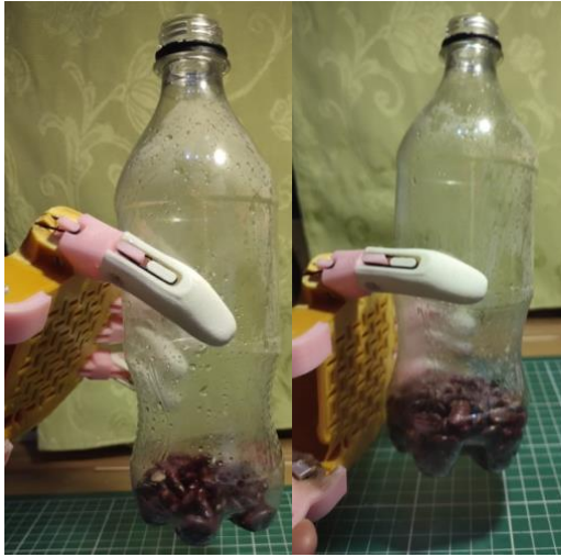
Imagen 45: prótesis tomando 50[g] a la izquierda y 100[g] a la derecha Fuente: Elaboración propia
