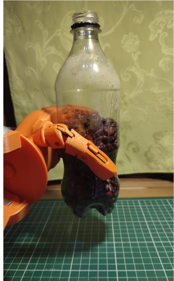
Imagen 44: Prueba peso máximo fuente: Elaboración propia
