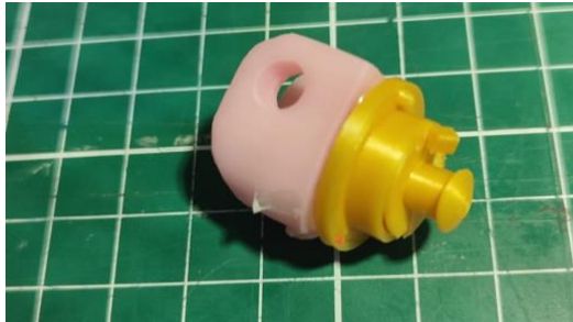
Imagen 44: conexión falange del pulgar con macho del sistema de rotación Fuente: Elaboración propia
