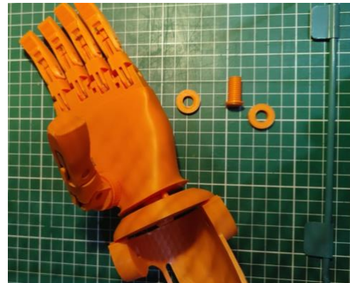
Imagen 44: sistema de rotación de muñeca junto a pruebas de hilo y tuercas
