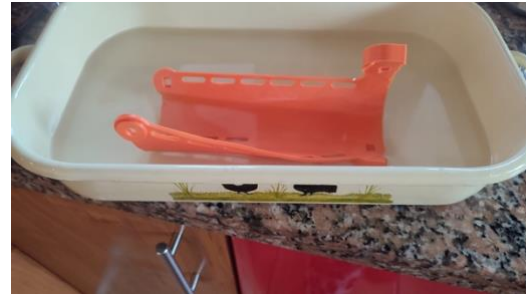
Imagen 44: Proceso de termoformado de antebrazo Fuente: Elaboración propia
