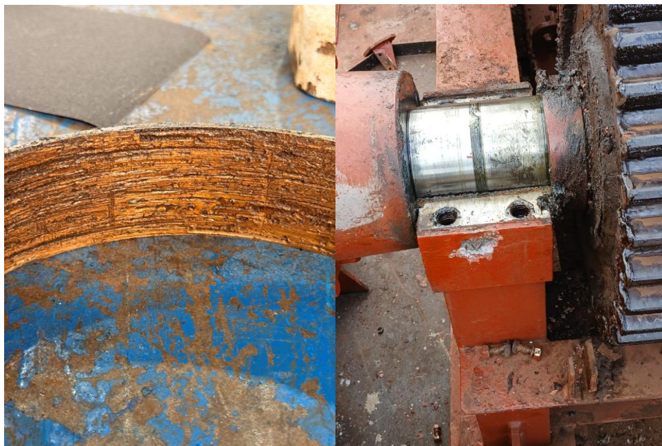
Ilustración 2-17.- Desmontaje del cabrestante (Bocina descanso)
