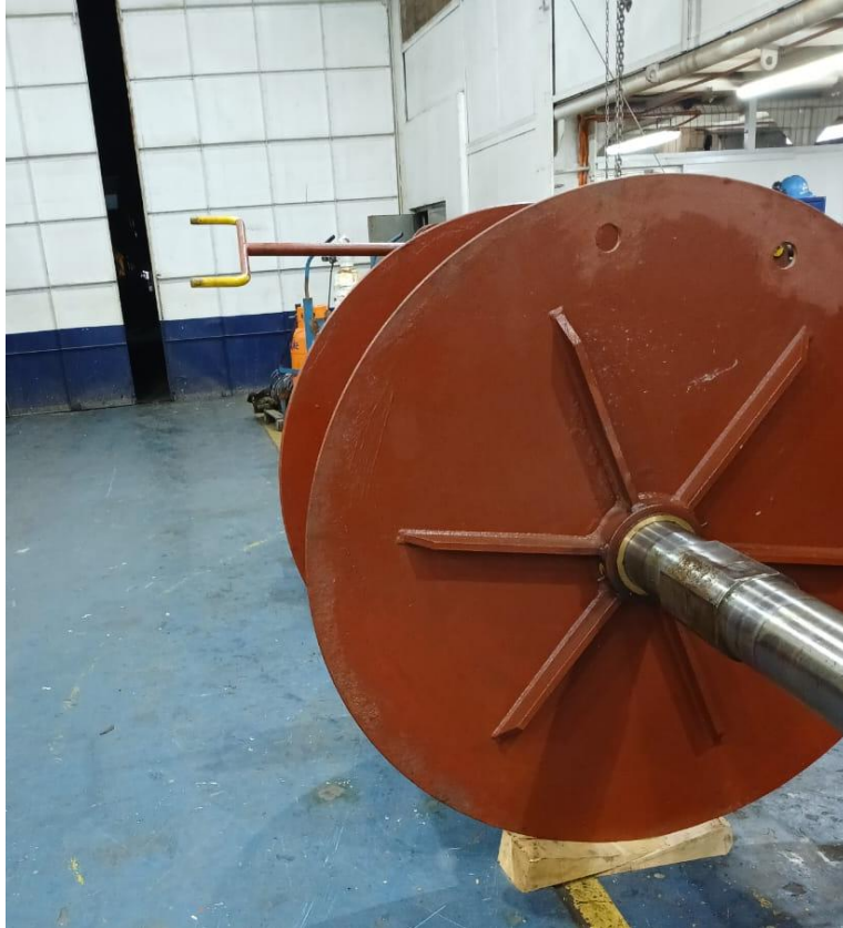
Ilustración 2-14.- Desmontaje del cabrestante (Eje)
