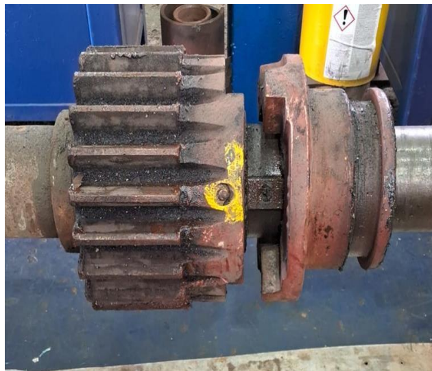
Ilustración 2-15.- Desarme de cabrestante (Encapillador y engranajes)
