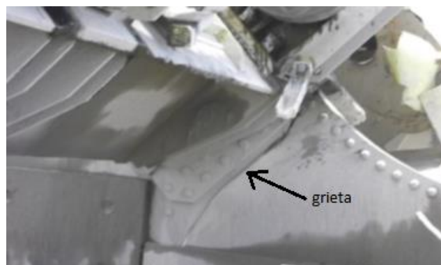
Figura 18: Fractura pieza principal interior.
