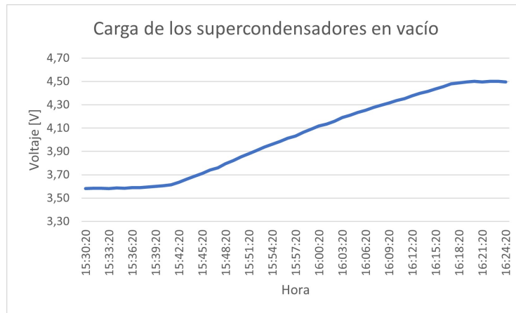
Figura 5.9: Carga de los supercondensadores sin conectar la salida.
