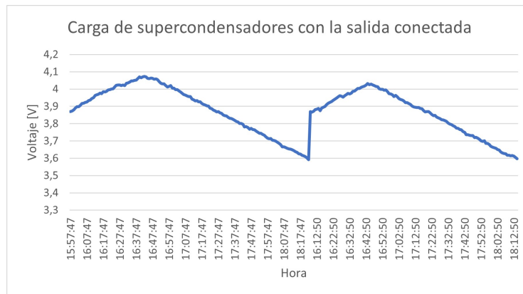
Figura 5.10: Carga de los supercondensadores con la salida conectada.
