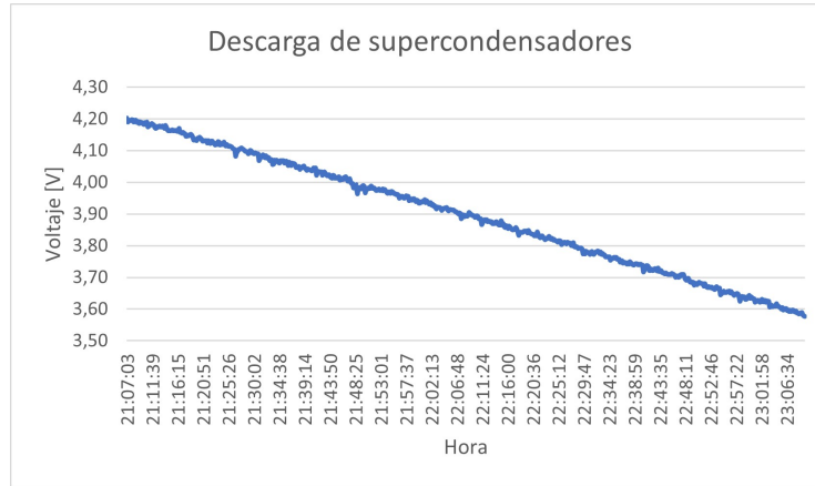
Figura 5.8: Descarga de supercondensadores alimentando el sistema a través del PMIC.
