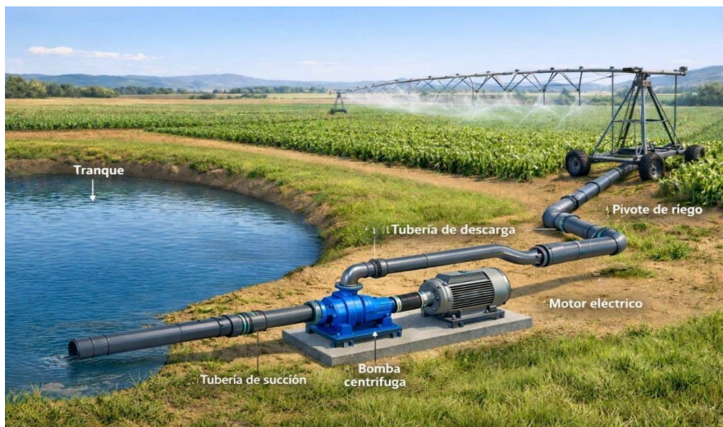
FIGURA 1-3. Sistema de bombeo e impulsión para riego por pivote central
