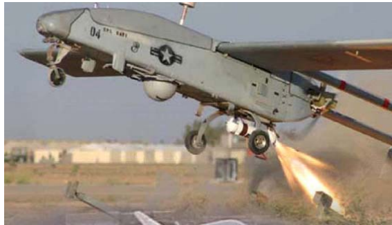
Figura 1.30: Cohete propulsor (fuente: Embry-Riddle Aeronautical University)
