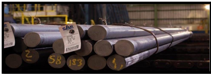
Ilustración 1-20 Barras Gruesas en mesa de traspaso de Romana
