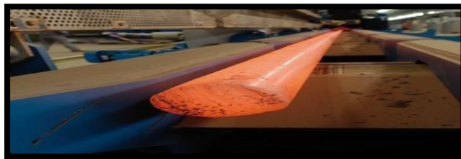
Ilustración 1-19 Barra de Acero especial en proceso de laminación
