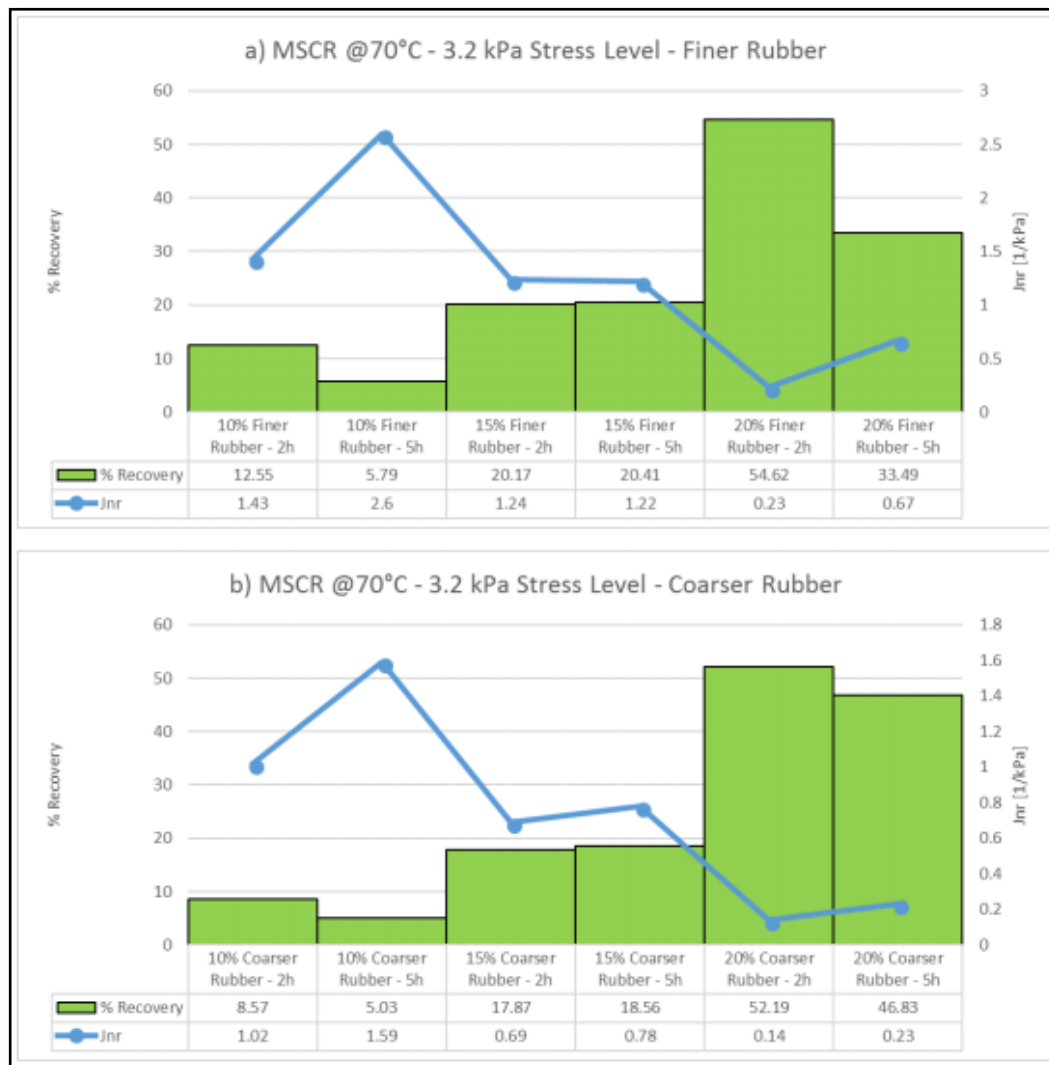
Figura A- 20: Porcentaje de recuperación y valores de Jnr según contenido de caucho y tiempo de reacción, Mandal T. & Bahia H., 2015.
