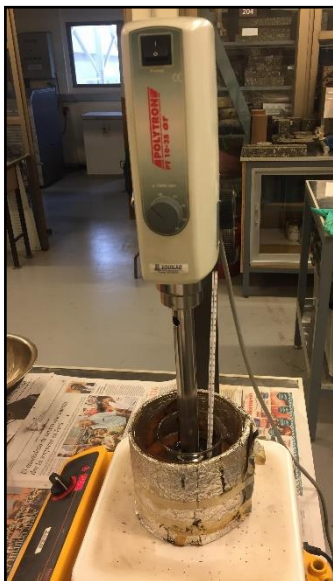
Figura 45: Proceso de modificación con ablandador, Elaboración propia.
