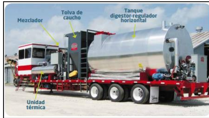
Figura 30: Unidad de fabricación con mezclador y tanque digestor, Bermejo J. et al. 2014.
