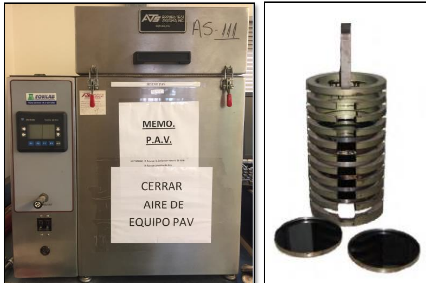
Figura 4: Cámara a Presión (PAV), LEMCO.
