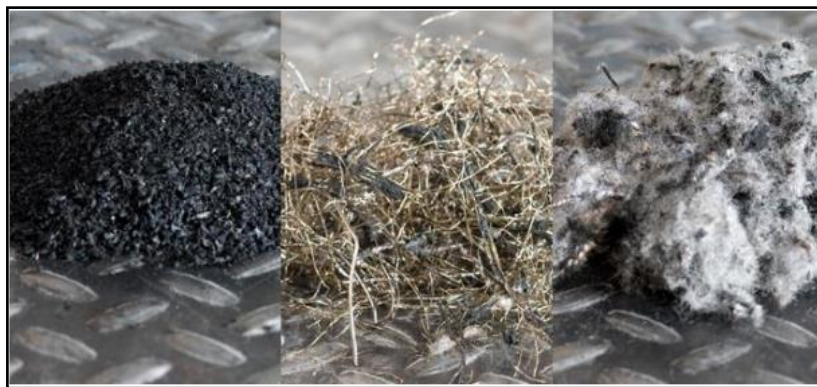
Figura 28: Polvo de caucho, acero y fibra textil luego del proceso de separación, Viveros J. & Pereira A., 2015.
