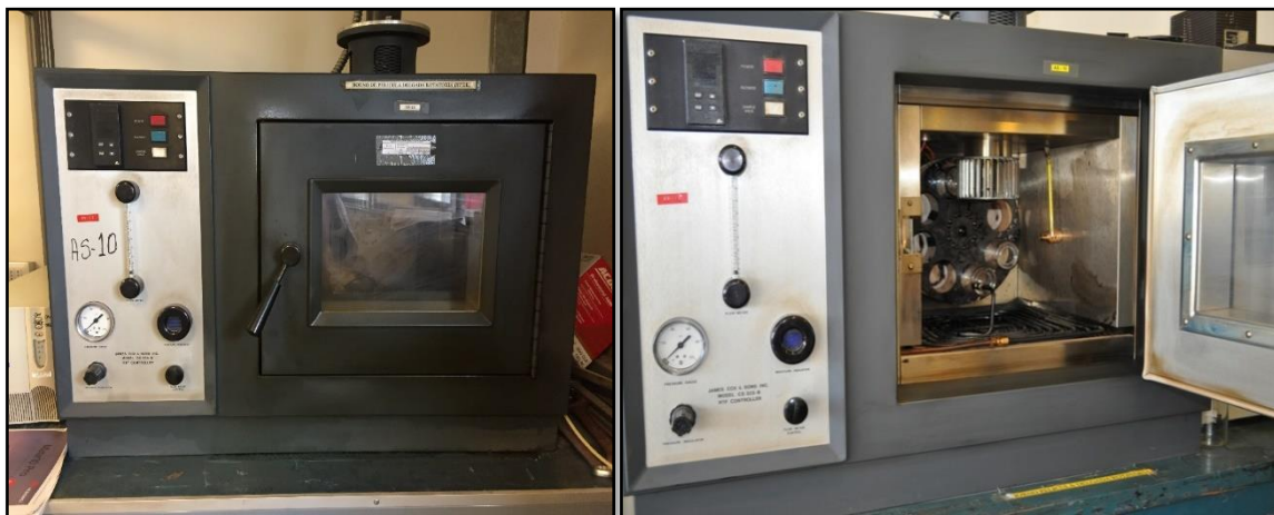
Figura 2: Horno de Película Delgada Rotatoria (HPDR), LEMCO.
