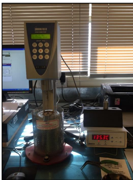
Figura 6: Viscosímetro rotacional de Brookfield, LEMCO
