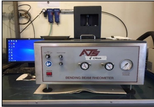
Figura 11: Reómetro de Viga de Flexión (BBR), LEMCO
