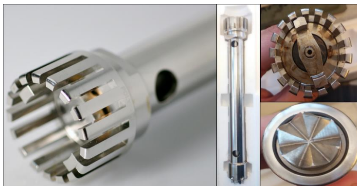
Figura 44: Vástago de mezclado POLYTRON-Aggregate Type PT-DA 30/2EC-F250, LEMCO.
