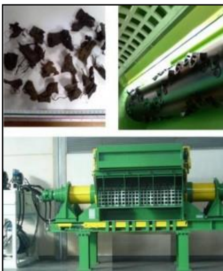
Figura 27: Trituración secundaria, reciclaje de llantas usadas, < http://www.vivoenitalia.com/linea-de-reciclaje-de-llantas-usadas/ >
