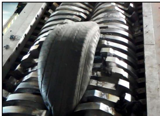
Figura 26: Trituración primaria, reciclaje de neumáticos < http://icore.es/portfolio_item/caucho-y-neumaticos/ >
