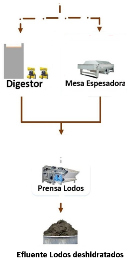
Figura 3.3: Diagrama flujo línea de lodos Planta Tratamiento Aguas servidas (Elaboración propia)
