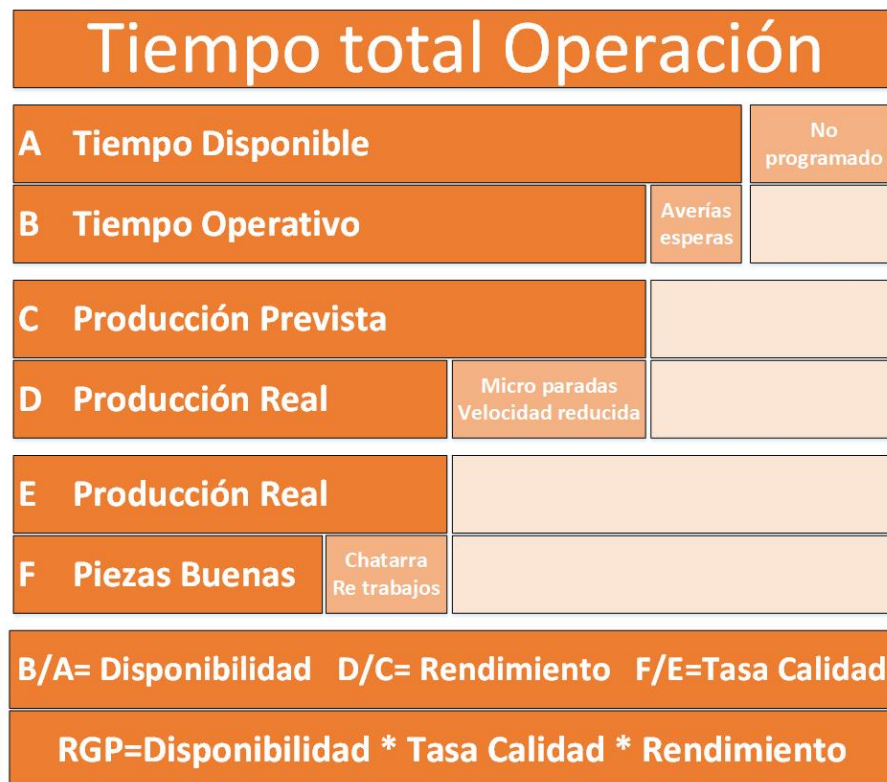
Figura 4.1: Diagrama esquemático para cálculo OEE
