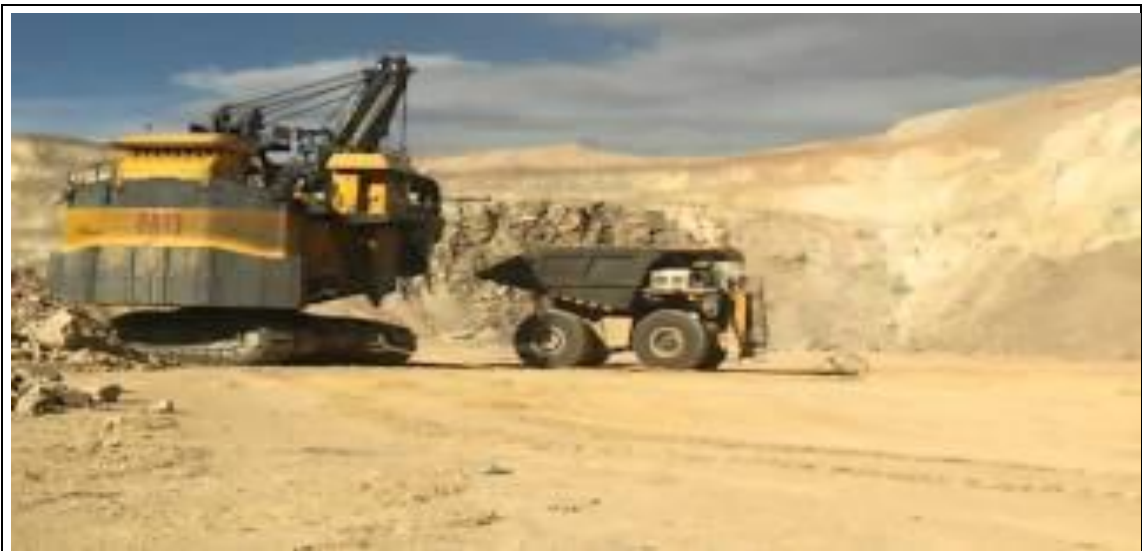
Fig. 1.1.1 Carga de mineral a camión de extracción 797 Caterpillar
