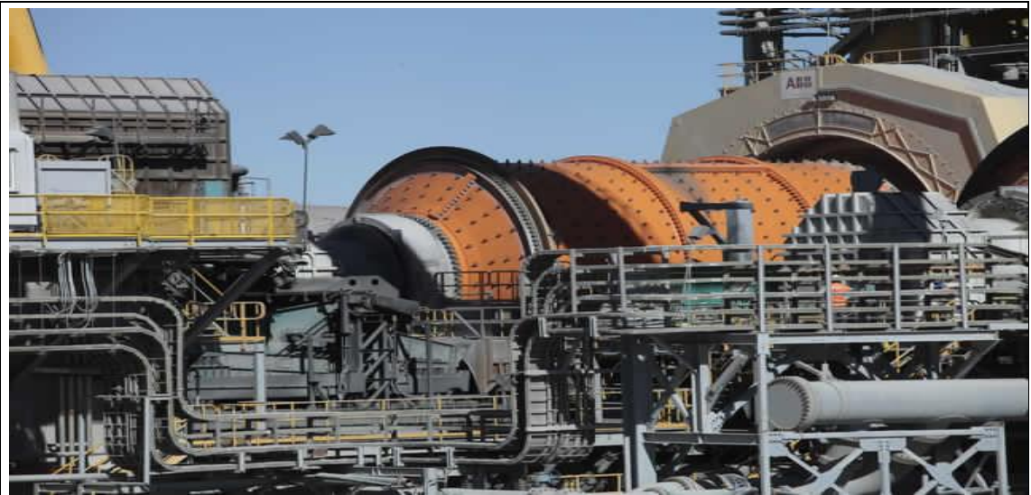
Fig. 1.3.2 Molino Semiautógeno de Compañía Minera Centinela. Fuente: Elaboración Propia en Área Planta Centinela Sulfuro.
