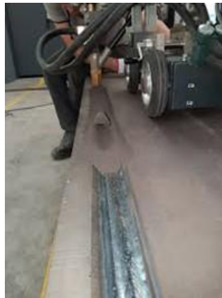
Figura 0.1: Soldadura a tope en placa larga. Fuente: Material propio
