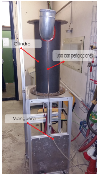
Figura 3.17: Diagrama para toma de muestra gaseosa en quemador radiante.
