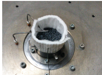
Figura 3.8: Matriz porosa posicionada recubierta con aislante.
