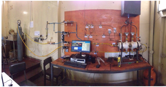
Figura 3.3: Instalación completa del reactor con todos los elementos.
