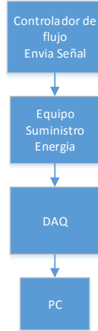
Figura 3.15: Diagrama flujo proceso lectura señales( feedback )
