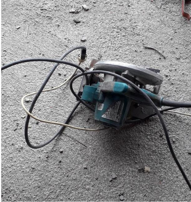
Figura 5-1. Muestra Sierra circular en terreno sin sistema de extracción localizada.
