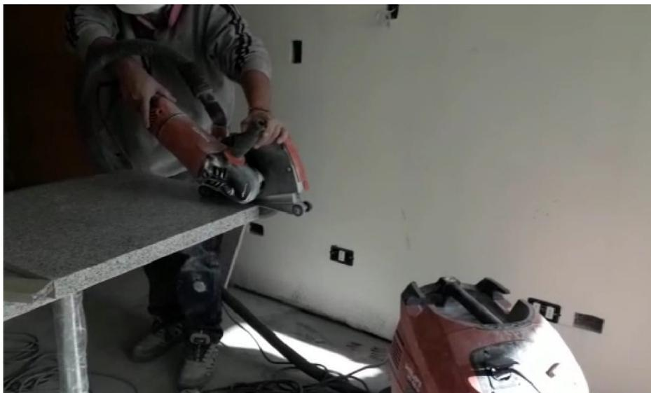
Figura 5-6. Implementación sistema de extracción localizada en esmeril angular.
