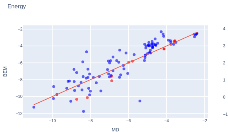
Figura 3.6: Gráfico de Energy Plots. \epsilon = 1,15 ; Moléculas con átomos de Nitrógeno; Coeficiente de Correlación = 0,8824; RMSD = 1,1425; MUE = 0,8164. En rojo destacadas las moléculas con presencia de Triple Enlace.
