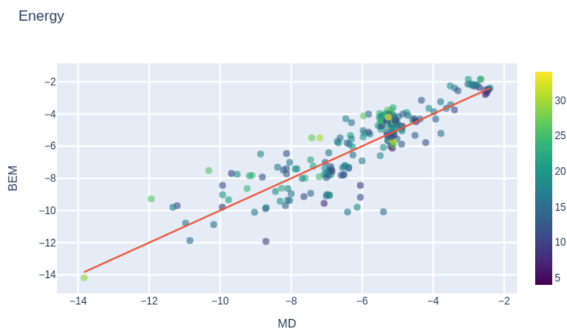
Figura 3.7: Gráfico de Energy Plots. \epsilon = 1,20 ; Moléculas con átomos de Oxígeno; Coeficiente de Correlación = 0,8704; RMSD = 1,1434; MUE = 0,9110. Barra de color representa el número de átomos.
