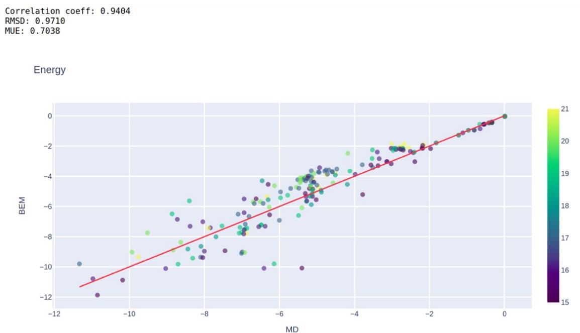
Figura 2.6: Gráfico de Resultados BEM (Pygbe) vs Dinámica Molecular, echo en el programa energy plots.
