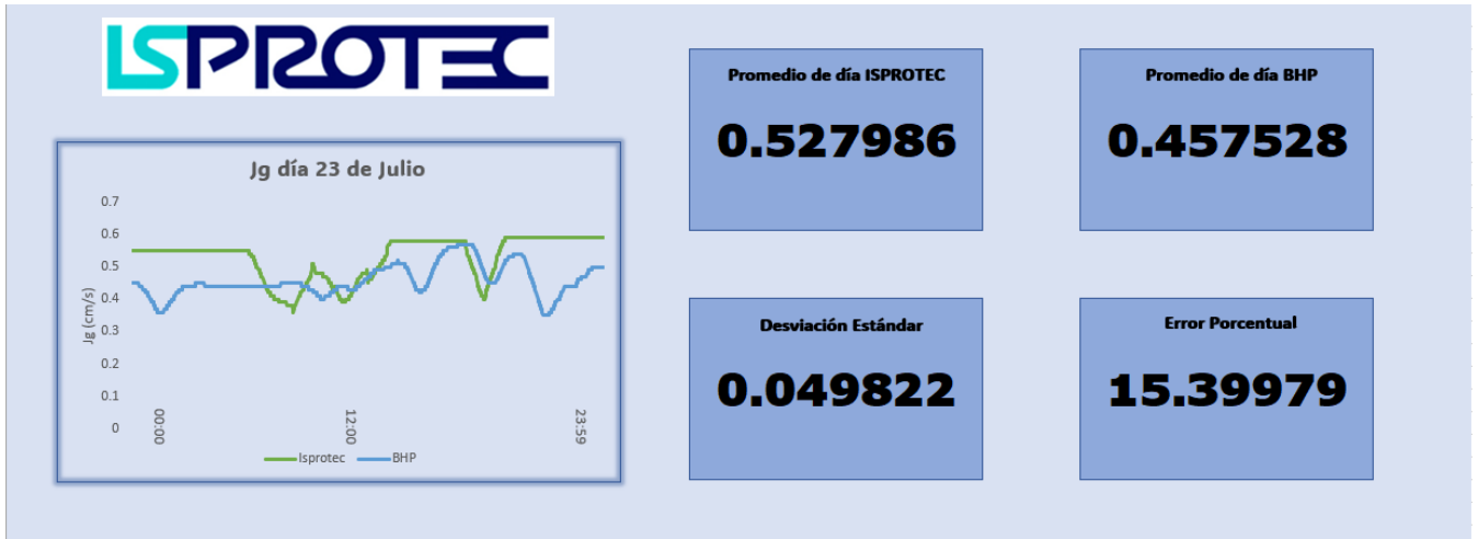
Figura 13.4: Medición de velocidad superficial del gas (Jg) 23 de Julio.
