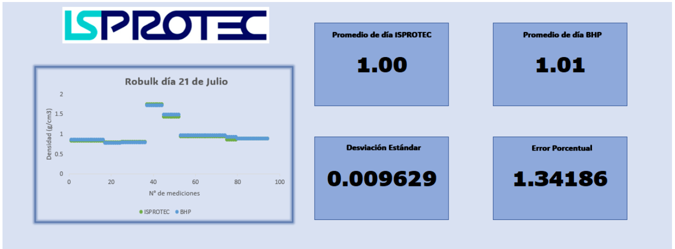
Figura 13.14: Medición de densidad de pulpa ( \rho_b ) 21 de Julio.
