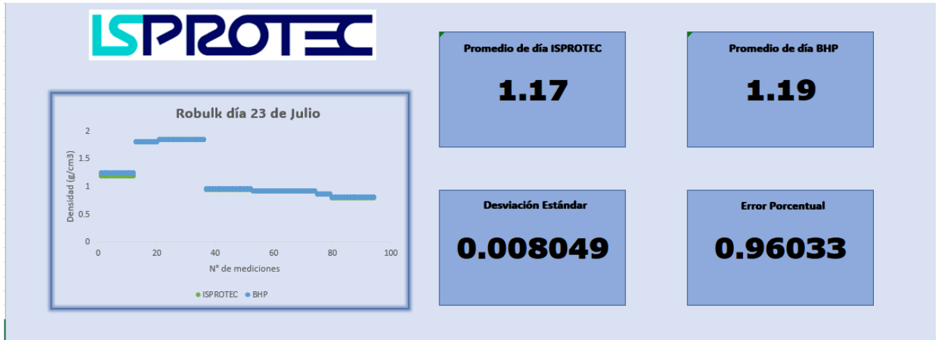
Figura 13.16: Medición de densidad de pulpa ( \rho_b ) 23 de Julio.
