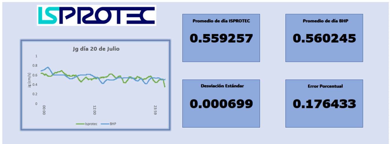
Figura 13.1: Medición de velocidad superficial del gas ( J_g ) 20 de Julio.
