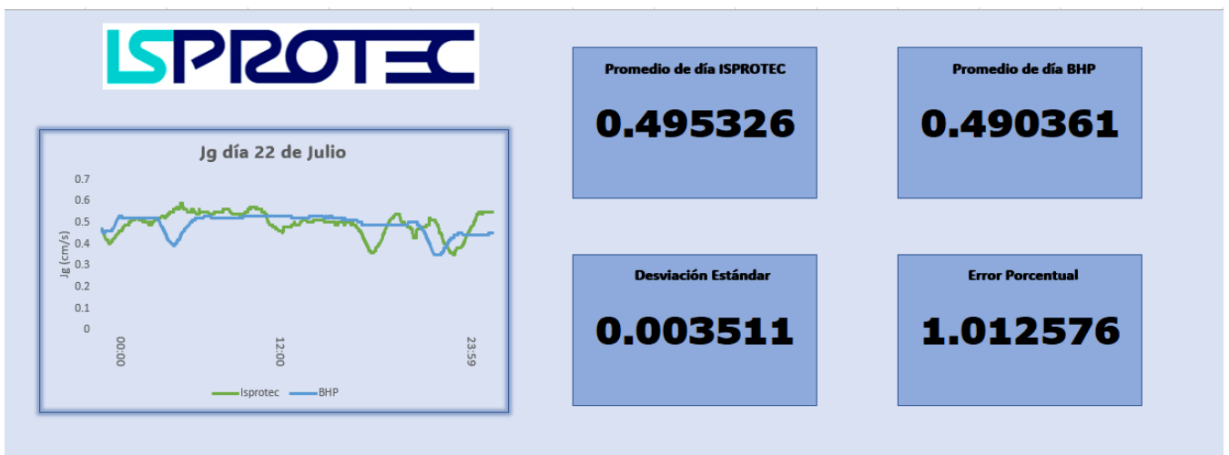
Figura 13.3: Medición de velocidad superficial del gas ( J_g ) 22 de Julio.
