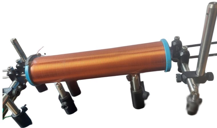
Figura 3.1: Bobina de inducción, implementada en el laboratorio de caracterización magnética.
