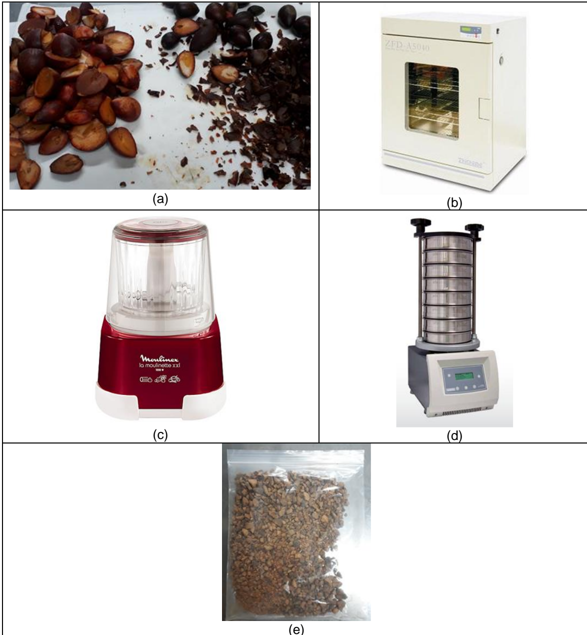
Figura 4.1-1: Resultados y equipos utilizados en pretratamiento de biomasa (a) hueso de palta sin tegumento (izq.) y residuo de la etapa (der.); (b) Estufa convectiva marca ZHICHENG modelo ZXFD-A5040 (Fuente: www.zhichengyq.com ); (c) Procesadora 1,2,3 Moulinex, DP800 (Fuente: moulinex.cl ); (d) Tamizadora Orto Alresa OASS 203 (Fuente: http://www.mainsolutions.eu ); (e) Almacenamiento de biomasa en bolsa plástica hermética.
