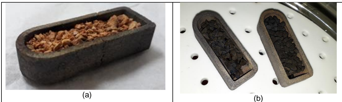
Figura 4.1-3: Biomasa alimentada a reactor (a) y carbón obtenido (b).
