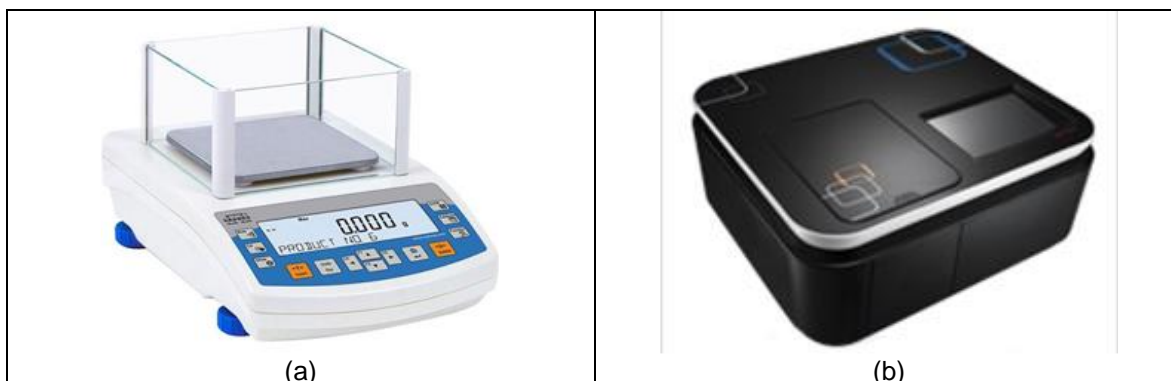
Figura 4.4-1: (a) Balanza semi analítica ragwag C1000 (Fuente: http://radwagusa.com ) y (b) Espectrofotómetro optizen pop de mecasys (Fuente: http://english.mecasys.co.kr ).
