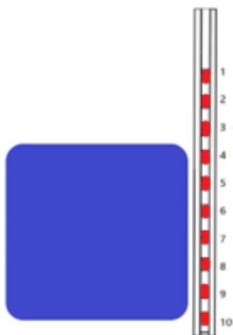
Figura 25. Imagen ilustrativa de fibra óptica y cilindro contenedor de puré de zanahorias. Fuente: elaboración propia.
