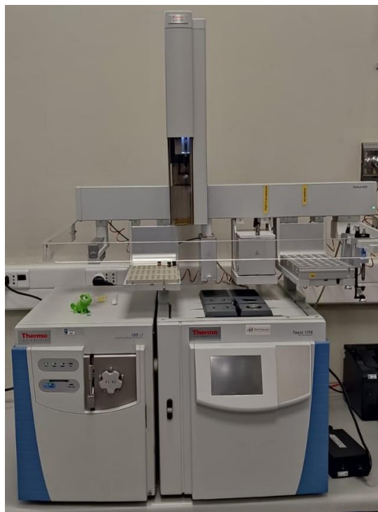
Figura 29. Imagen de cromatógrafo de gases utilizado para los análisis.
