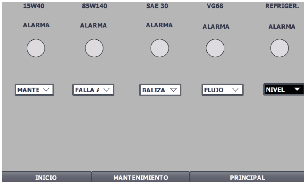
Figura 2.27. Pantalla de alarmas en Tia portal.
