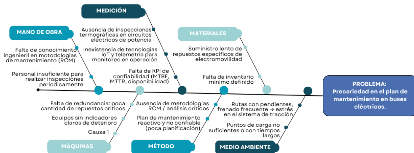
Imagen 2-2: Diagrama de Ishikawa sobre la precariedad del plan de mantenimiento en buses eléctricos.
