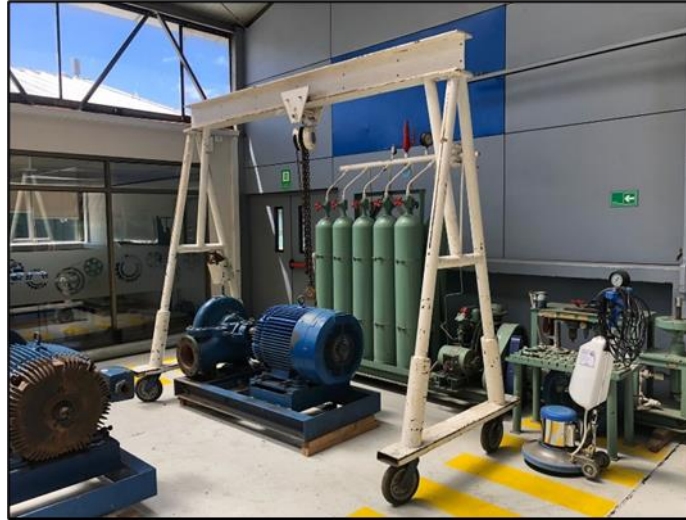
Figura 2-3. Grúa portal en Taller de Mantenimiento Industrial
