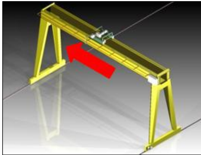
Figura 1-19. Movimiento transversal del trolley
