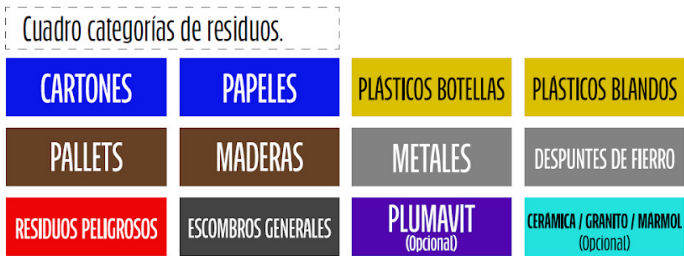
Figura 8. Categorías de residuos a reciclar en obra.
