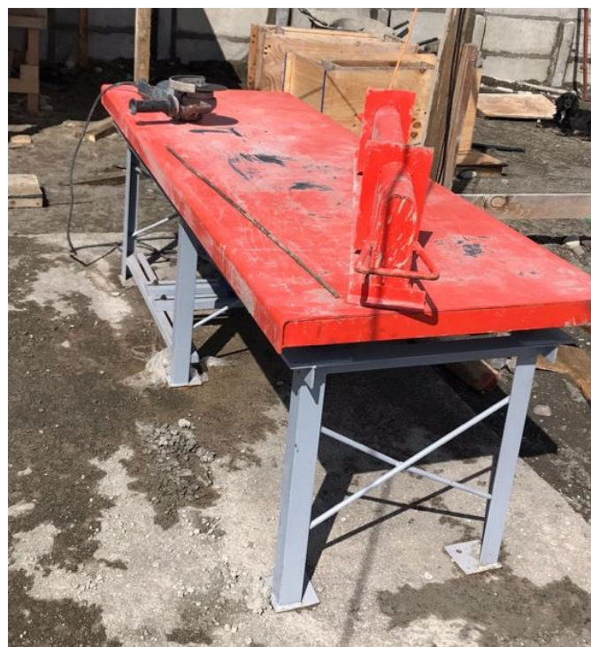
Figura 14. Mesa vibradora y solerilla adquiridas por la empresa.
