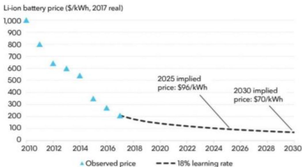
Gráfico n°3: Precio apreciado de manufactura de una batería de ion-litio en el mercado hasta 2017, la línea punteada corresponde a la baja en el precio esperado para los siguientes años.
