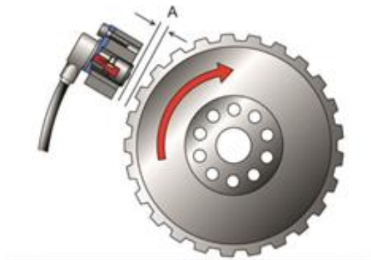
Figura 2- 6 sensor inductivo de efecto hall
