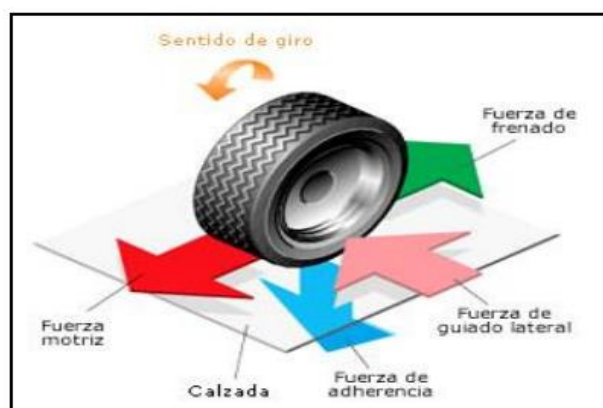
Figura 1- 22 Fuerzas que actúan sobre la rueda
