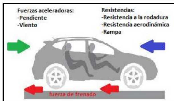
Figura 1- 24 Fuerzas de frenado
