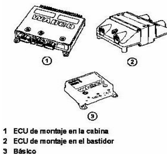
Figura 1- 11 Unidad de control ABS
