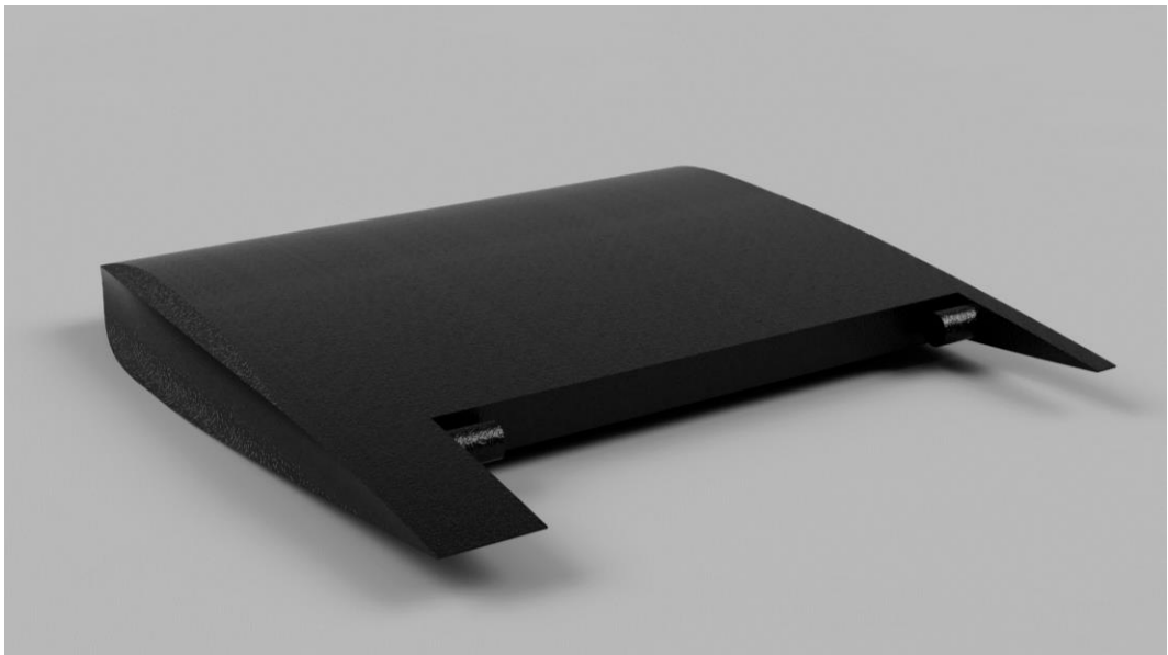
Figura 2-32. Imagen renderizada del elevador derecho
