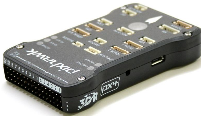
Figuras 1-14. Controlador de Vuelo de Drones PIXHAWK
