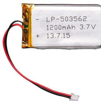
Figuras 1-13. Batería de Polímero de Litio 3.7V 1200mAh
