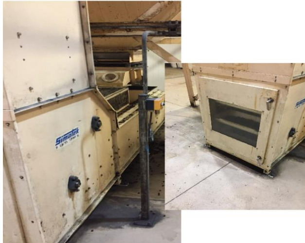
Figura.1-13.- Extrusora creadora de pellet.
