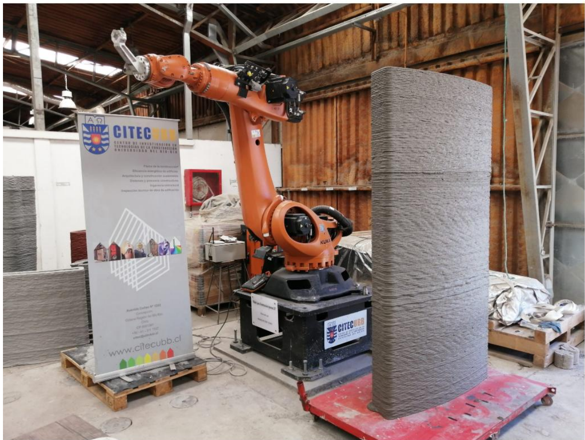
Fig. 3: Muro impresión 3D, altura 2.20 m, Grupo Construcción Impresa UBB.
