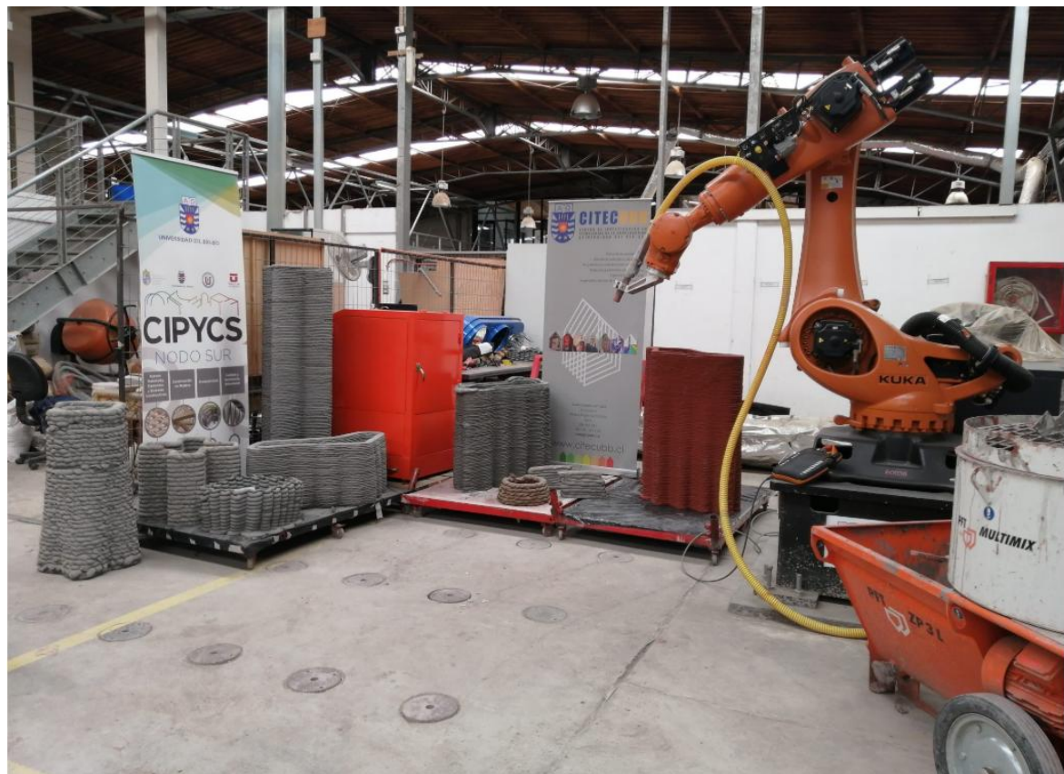
Fig 4: Prototipos Hormigón 3D, Grupo Construcción Impresa UBB.
