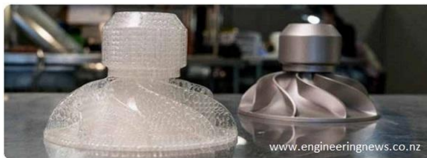
Figura 2-17 Comparativa modelo maestro de impresión 3D y pieza final [11].
