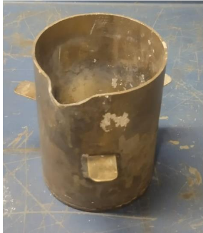
Figura 6-7 Crisol de acero inoxidable elaborado en el taller.
