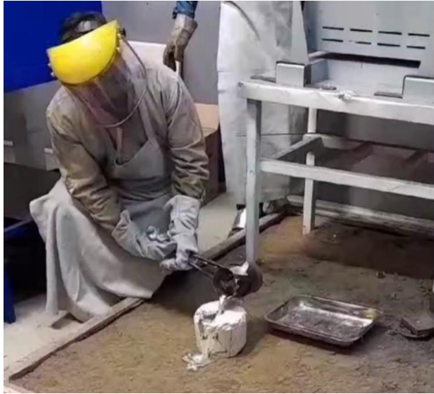
Figura 3-14 vertido de metal fundido en molde.
