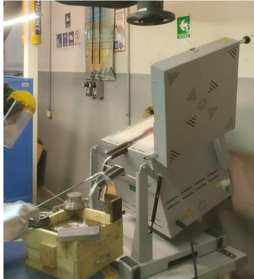
Figura 6-10 1er procedimiento de colado.
