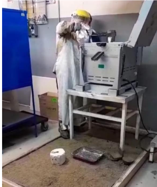
Figura 3-12 Pre calentamiento de crisol.
