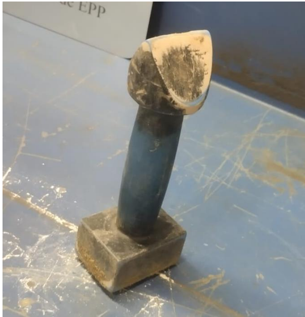
Figura 4-8 Apisonador de arena realizado con impresión 3D.
