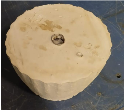
Figura 3-9 Molde post quemado PLA
