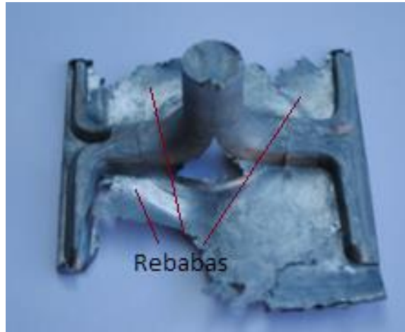
Figura 2-30 Defecto de rebabas [6].
