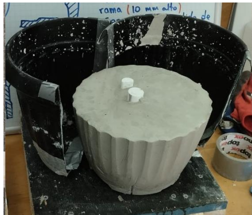
Figura 3-8 paso 7: Extracción del molde
