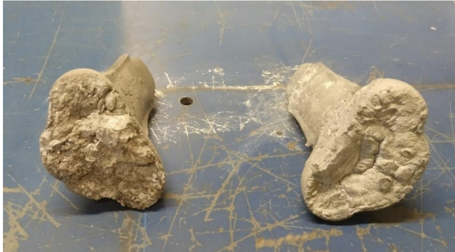
Figura 6-19 Resultados 2da prueba PLA perdido.
