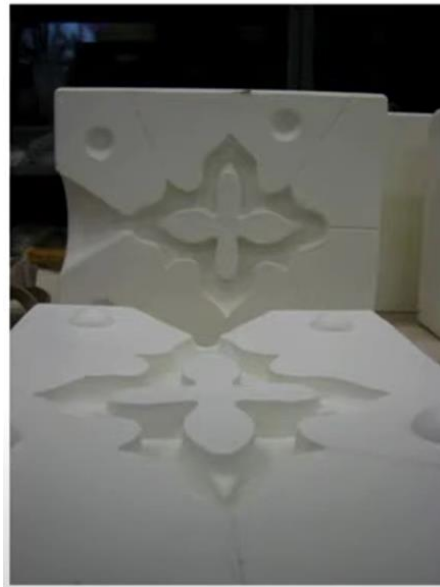
Figura 2-15 Molde de yeso dividido [10].
