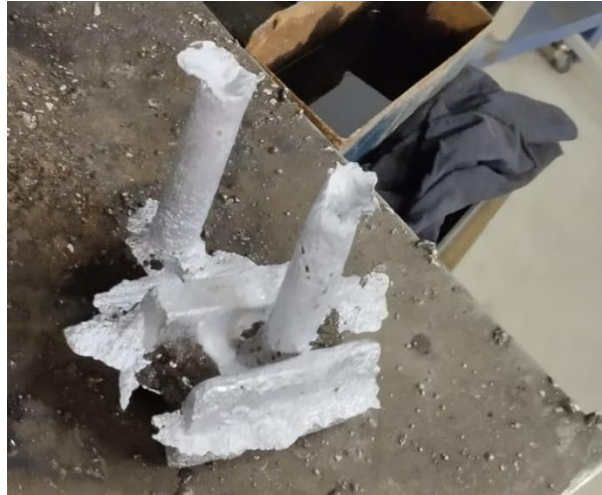
Figura 6-13 2da prueba de fundición en arena.
