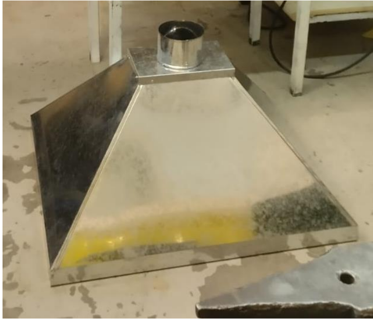
Figura 4-3 Campana de extracción.
