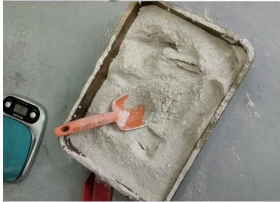
Figura 3-4 paso 4: mezclado de yeso-cemento.
