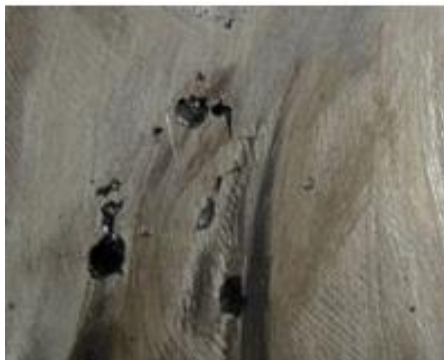
Figura 2-31 Defecto de vitrificaciones [6].
