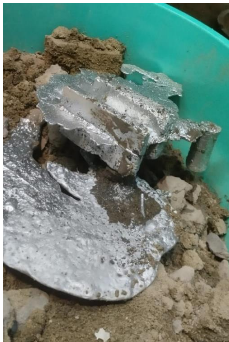
Figura 6-11 1era prueba de fundición en arena.
