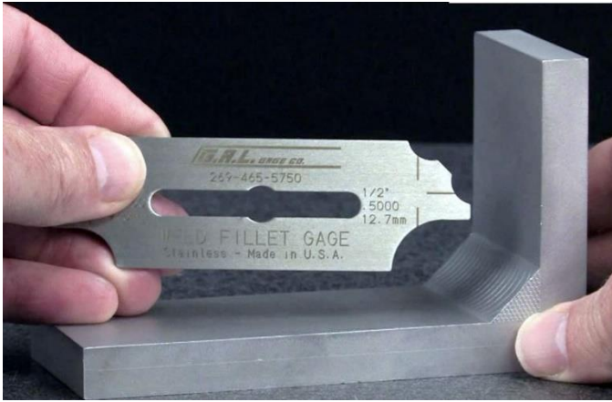
Figura 1-2 Revisión de un cordón de soldadura con lanas.
